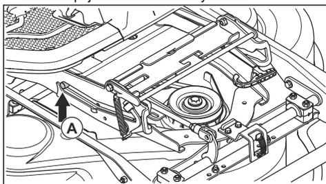
8. Zvedněte podpěru výšky sečení z držáku podpěry
