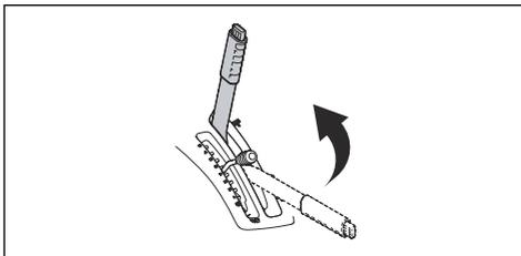
A vágóasztal fűnyírási pozícióba történő leengedéséhez nyomja meg a rögzítőgombot, és állítsa előre az emelőkart. Járó motor esetén a kések automatikusan forogni kezdenek.
