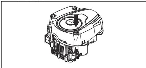
4. Zetrzeć olej z prętowego wskaźnika poziomu oleju.
