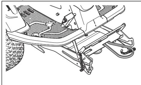
6. Tolja lefelé a vázszerkezetet. Emelje a szervizpozíció rögzítését függőleges helyzetbe.
