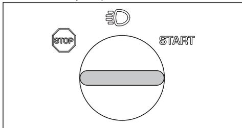
4. Po uruchomieniu silnika natychmiast przekręcić kluczyk z powrotem do położenia neutralnego.
