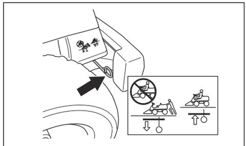
W modelu R 320X AWD dźwignia układu napędowego dla osi przedniej znajduje się za przednim lewym kołem.
