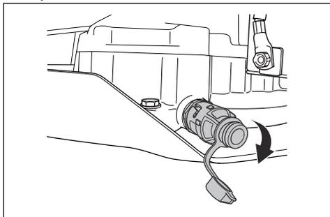
2. Pro usnadnění vypuštění oleje bez vylití nasadte na konec vypouštěcí zátky oleje například plastovou hadici.
