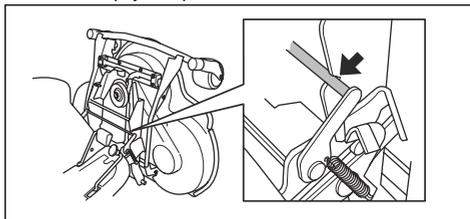
3. Sklopte žací ústrojí a zatlačte jej nadoraz.
