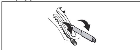
5. Ustawić pasek napędowy w sposób przedstawiony na ilustracji, aby upewnić się, że nie zostanie on zaklinowany ani przerwany podczas montażu zespołu tnącego.
