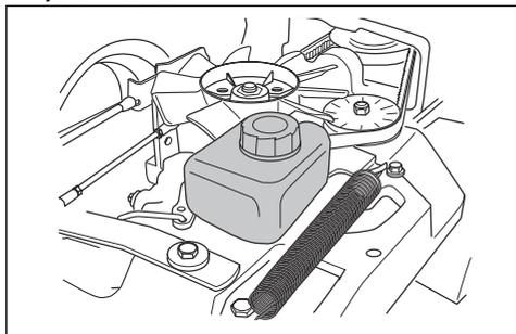
3. Pokud je hladina oleje pod dolní ryskou, doplňte motorový olej. Hladina však nesmí být nad horní ryskou.
