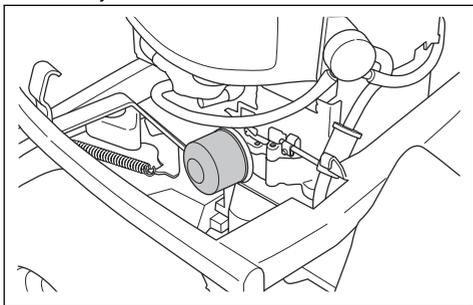
10. Gumené tesnenie na novom olejovom filtri mierne namažte novým olejom.
