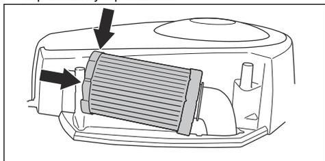
8. Zamocować pokrywę filtra powietrza i dokręcić pokrętkę.
