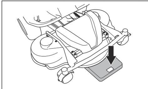
5. Aby bylo zajištěno, že nebude na opěrná kola působit žádné zatížení, vložte dřevěný špalek mezi rám a osobní váhu.
