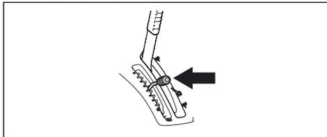
6. Nacisnąć przycisk blokady na dźwigni regulacji wysokości zespołu tnącego i opuścić go do położenia koszenia.
