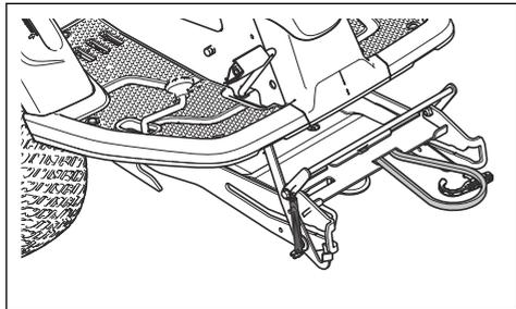
6. Zatláčte rám zariadenia nadol. Zdvihnite servisný zámok do vertikálnej polohy.
