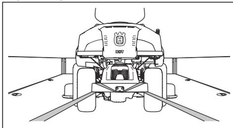
8. Napnutím popruhu smerom dozadu zaistíte výrobok k nakladacej ploche.
