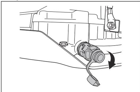
2. Az olaj kifröccsenés nélküli leeresztésének megkönnyítésére kapcsoljon például műanyag tömlőt az olajleeresztő csavar végéhez.
