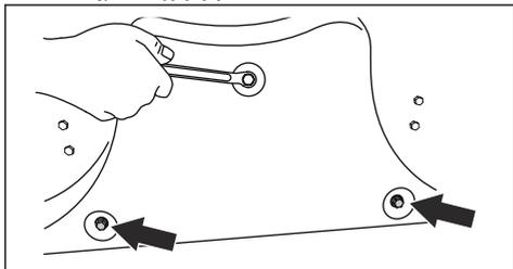
3. Włożyć 3 śruby M8x15 mm w otwory na śruby wkładki BioClip, aby zapobiec uszkodzeniu gwintów.
