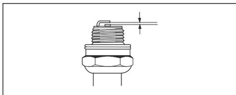
6. Zgiąć elektrodę boczną, aby wyregulować odstęp pomiędzy elektrodami.
