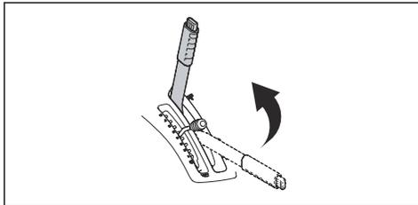
Na spustenie kosiaceho zariadenia do polohy kosenia stlačte poistné tlačidlo a posuňte zdvíhaciu páku dopredu. Ak motor beží, čepele sa automaticky začnú otáčať.
