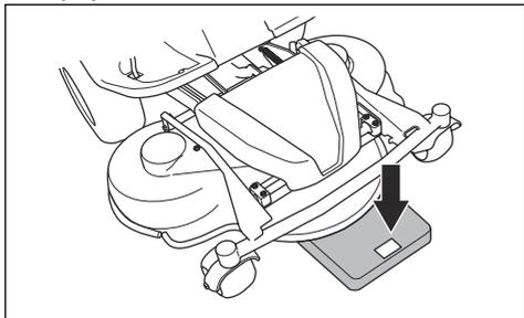
5. Medzi rám a váhu položte drevený kváder, aby ste mali istotu, že žiadnu váhu nenesú oporné kolieska.
