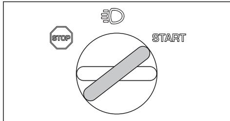
**Povšimněte si:** Nezapínejte startér na déle než 5 sekund. Pokud motor nespustíte, před dalším pokusem počkejte 15 sekund.
