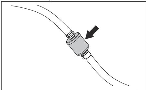
5. Zatlačte nový palivový filtr do konců hadic. Naneste kapalný čisticí prostředek na konce palivového filtru, aby se usnadnilo připojení.
