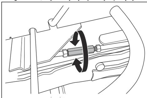
5. Dokręcić nakrętki na podporze podnoszącej po wykonaniu regulacji.
