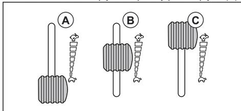
**Poznámka:** Aktivovaním čepeľí pri maximálnych otáčkach motora sa namáhajú hnacie remene. Plný plyn pridajte, až keď kosiace zariadenie spustíte do polohy kosenia.
