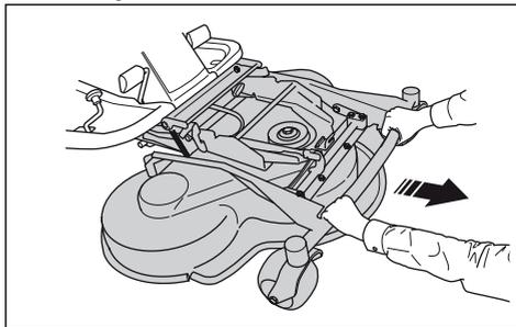
3. Emelje fel a vágóasztalt függőleges helyzetbe, amíg kattanó hangot nem ad. A vágóasztal automatikusan függőleges helyzetben rögzül.
