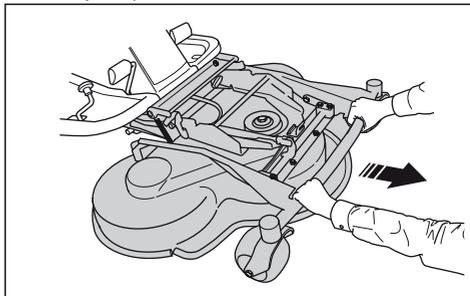
3. Zvedněte žací ústrojí do svislé polohy, dokud neuslyšíte cvaknutí. Žací ústrojí se automaticky zajistí ve svislé poloze.
