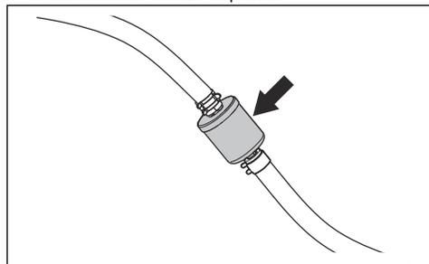
5. Zatlačte nový palivový filter do koncov hadíc. Na konce palivového filtra naneste tekutý čistiaci prostriedok, aby sa filter ľahšie pripájal.
