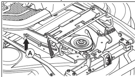
8. Zdvihnite poistku výšky rezu z držiaka poistky a vložte ju do otvoru pre poistku výšky rezu (A).
