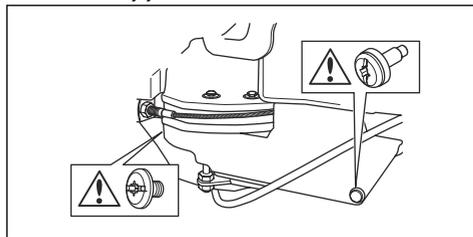
2. Mazání proveďte pomocí mazací pistole přes maznici na pravé straně pod dolní řemenicí. Napínač promažte tak, až mazivo začne vytékat zadní stranou maznice.
