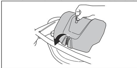
3. Poluzować naprężenie koła napinającego pasek napędowy. (A)
