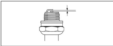
6. Medzeru medzi elektródami upravte ohnutím bočnej elektródy.
