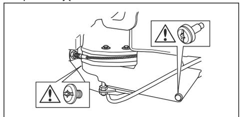
2. Nasmarować za pomocą smarownicy tłokowej przez smarowniczkę po prawej stronie, pod dolnym kołem pasowym. Smarować do momentu, aż smar zostanie wypchnięty z tyłu smarownicy.
