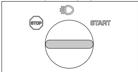
4. Keď motor naštartuje, ihneď pusťte kľúč zapalovania späť do neutrálnej polohy.
