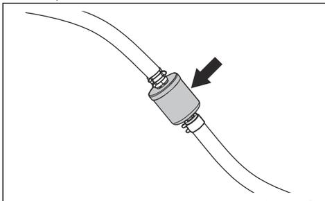
5. Wcisnąć nowy filtr paliwa w końcówki przewodów. Zastosować płynny detergent na końcówkach filtra paliwa, aby ułatwić połączenie.
