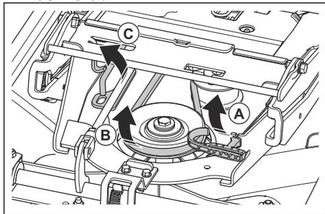
4. Przytrzymać rączkę sprężyny lewą ręką i zdjąć pasek napędowy prawą ręką.
