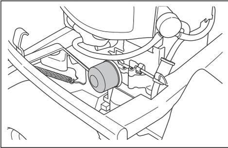
10. Delikatnie nasmarować gumową uszczelkę na nowym filtrze oleju za pomocą nowego oleju.
