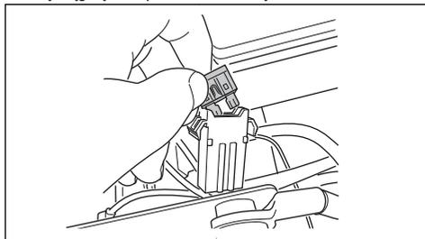
3. Wymienić przepalony bezpiecznik na nowy bezpiecznik tego samego typu, z płaskim stykiem, 20 A.
