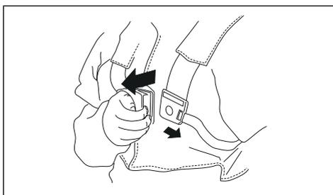
In caso di emergenza, la funzione di rilascio rapido consente di rimuovere il dispositivo in modo sicuro.
