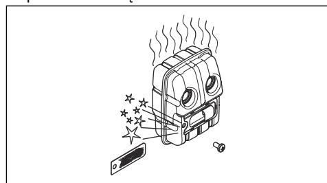
4. Oczyścić siatkę przeciwickrową, jeśli jest ona zapchana. Wymienić ją w przypadku uszkodzenia.
