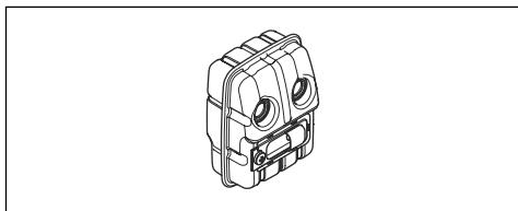
Tlmič výfuku slúži na udržovanie minimálnej hladiny hluku a na smerovanie výfukových plynov smerom od obsluhy.
