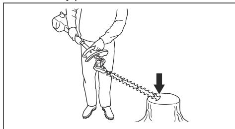
4. Nakloňte rezné zariadenie do polohy používania.
