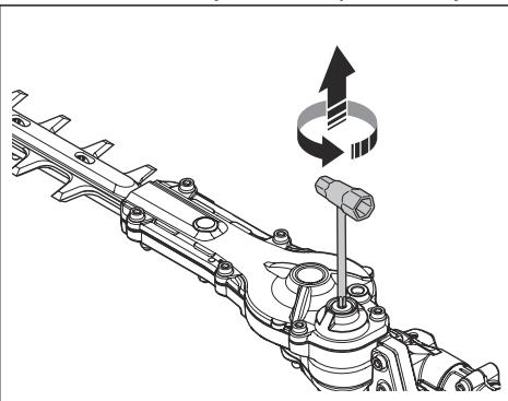
2. Zasuňte kombinovaný kľúč do skrine prevodovky a otáčajte v smere a proti smeru hodinových ručičiek. Skontrolujte, či sa čepele voľne pohybujú.
