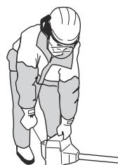
4. Pomalu vytáhněte rukojet' startovací šňůry, než ucítíte odpor, a poté silou zatáhněte za rukojet' startovací šňůry.
