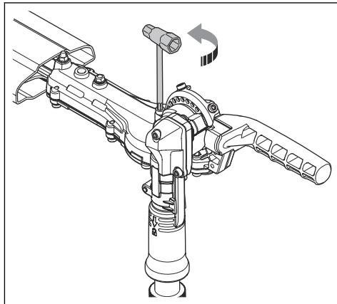
5. Állítson a csavaron a súrlódás beállításához.
