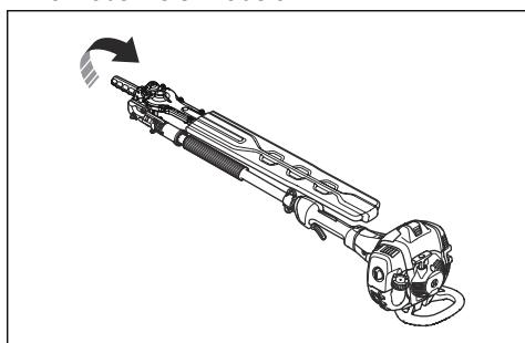
4. Uvoľnením rukoväti na nastavenie polohy zaistite rezné zariadenie.
