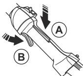
2. Zkontrolujte, zda se při uvolnění pojistky páčky plynu zajistí páčka plynu v nastavení volnoběžných otáček.
