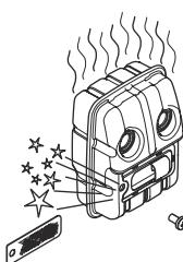
4. Pokud je lapač jisker znečištěný, vyčistěte jej, nebo jej vyměňte, pokud je poškozený.
