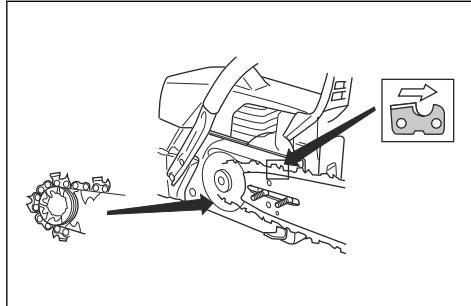
6. Подравнете отвора в направляващата шина с регулираща ос на веригата и монтирайте капака на съединителя.
