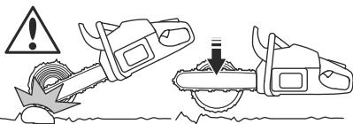
**ПРЕДУПРЕЖДЕНИЕ:** Уверете се, че веригата за моторен трион не докосва земята при завършване на разреза.
