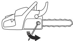
**Забележка:** Някои модели имат само една гайка на шината.
