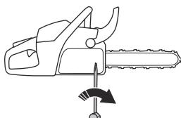
5. Затегнете гайките на шината с гаечния ключ и същевременно повдигнете предната част на направляващата шина.
