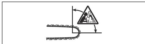
キックバックは、常にガイドバーの切削面で起こります。通常、本体は作業者に向かって跳ね返りますが、別の方に向かう場合もあります。キックバック発生時に本製品をどのように使用していたかによって、キックバックの動きの方向が決まります。
