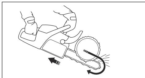
**警告:** ソーチェンが幹に引っかかると、製品が作業者に向かって押し出されます。製品をしっかりと持ち、ガイドバーのキックバックゾーンが木に触れておらず、キックバックが発生しないことを確認します。
