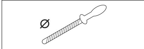
ソーチェンの目立てを正しく行うには、適切な装置を使用する必要があります。Husqvarna 製目立てゲージを使
