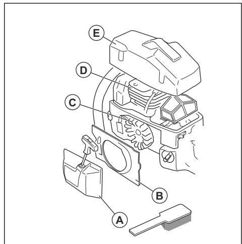
1. 必要に応じて、ブラシを使用して週に 1 回以上の頻度で冷却システムを清掃してください。
