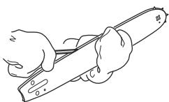
4. ガイドバーの溝に摩耗がないか調べます。摩耗がある場合は、ガイドバーを交換します。
