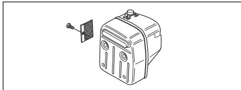
4. 破損したスパーク防止ネットは交換してください。
