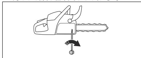
5. レンチを使用してバーナットを締め込みながらガイドバーの前方を持ち上げます。
