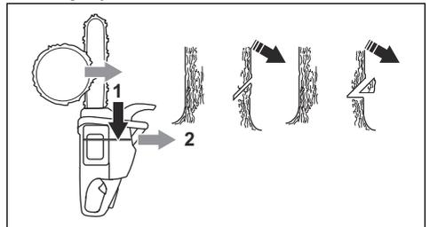
2. Spodnji smerni rez mora biti vodoraven in pod kotom  $90^{\circ}$  glede na smer podiranja.
