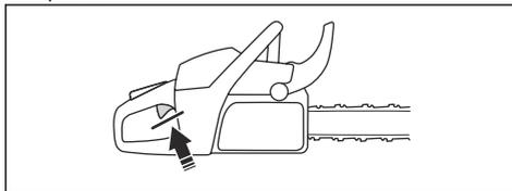
4. Zaženite izdelek in pritisnite polni plin.
