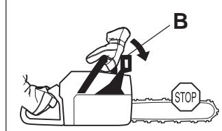
Taj pokret aktivira jedan mehanizam nategnut oprugom koji nateže traku kočnice (C) oko pogonskog sistema lanca (D) ("bubnja kvačila").
