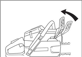
Odvrni maticu mača i skini pokrivač kvačila (kočnicu lanca). Odstrani zaštitu za transport (A).
