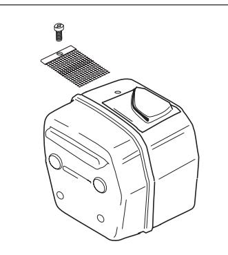
Ako je i tvoja pila opremljena jednim takvim prigušivačem zvuka treba mrežicu očistiti jednom sedmično a najbolje je čistiti sa čeličnom četkom.
