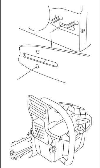
Lanac je dobro zategnut ako ne visi opušteno sa donje strane mača ali se ipak može okretati ručno. Zavrni maticu mača čvrsto sa kombi ključem držeći istovremeno vrh lanca gore. Na novom lancu se moraju vršiti češće kontrole zategnutosti često dok se lanac uhoda. Dobar lanac daje veći učinak rezanja i dužinu trajanja.
