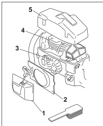
Čisti rashladni sistem četkom jedanput sedmično ili češće po potrebi. Nečist ili ponovo montiran rashladni sistem prouzrokuje pregrijavanje pile i oštećenja na cilindru i klipu.
