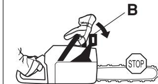
El movimiento activa un mecanismo cargado por muelle que tensa la cinta del freno (C) alrededor del sistema de arrastre de la cadena (D) en el motor ("tambor de embrague").
