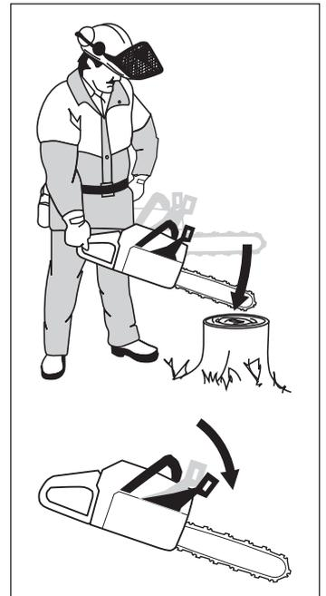
El freno de cadena debe activarse cuando la punta de la sierra contacta con el tocón.
