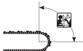
Отдача всегда происходит в плоскости резания пилы. Обычно при отдаче моторную пилу отбрасывает назад и вверх в направлении рабочего. Тем не менее моторная пила в момент отдачи может двигаться в различных направлениях в зависимости от метода резки, который применялся в момент касания зоны отдачи полотна и объекта.
