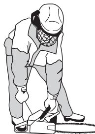
После того, как двигатель сделает первую вспышку, верните сразу рычаг воздушной заслонки в первоначальное положение, открывая воздушную заслонку, и повторите запуск. Когда двигатель запустится, дайте полный газ и отпустите рычаг дроссельной заслонки и блокировка пускового положения дроссельной заслонки отключится.
