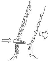
Мы рекомендуем пользоваться шиной пилы, длина которой бы превышала диаметр ствола, чтобы валящий и направляющий срезы могли выполняться т.н. "одинарным срезом". См. указания в разделе Технические данные, относительно рекомендуемой длины шины пилы для Вашей модели моторной пилы.
