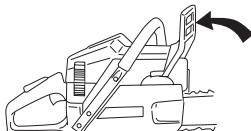
Desatarraxe inteiramente as porcas e remova a cobertura de acoplamento (travão de corrente). Retire o protector para transporte (A).
