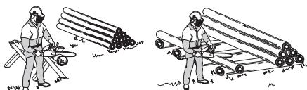
**O tronco está deitado sobre o solo.** Não há nenhum risco da corrente se prender ou de fendilhamento do objecto a serrar. O risco é, entretanto, grande de que a corrente toque o solo após a serração de fora a fora.
