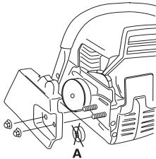
Monte la espada en los pernos. Sitúela en la posición posterior extrema. Monte la cadena en el piñón de arrastre y la guía de la espada. Empíeza con la parte superior de la cadena.
