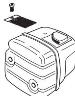
El silenciador está diseñado para amortiguar el ruido y para apartar del usuario los gases de escape. Los gases de escape están calientes y pueden contener chispas que pueden ocasionar incendios si se dirigen los gases a materiales secos e inflamables.
