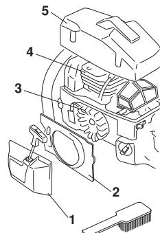
Limpe o sistema de arrefecimento com uma escova, uma vez por semana, ou com mais frequência, em condições de trabalho difíceis. O sistema de arrefecimento obstruído ou sujo conduz a um sobreaquecimento da máquina, danificando o cilindro e o pistão.
