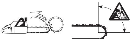
Serrar com a parte inferior da lâmina, ou seja, serrar a partir do lado superior do objecto a ser serrado, e para baixo, chama-se serrar com a corrente a puxar. Então a moto-serra é puxada contra a árvore e o canto anterior do corpo da moto-serra forma um apoio natural contra o tronco. Serração com a corrente a puxar possibilita ao utilizador um melhor controlo sobre a moto-serra bem como sobre onde o sector de risco de retrocesso da lâmina está localizado.
