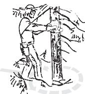
Remova a vegetação do solo em volta da árvore e prepare-se para eventuais obstáculos (pedras, galhos, buracos, etc.) de modo que possa fugir facilmente quando a árvore começar a cair. O caminho de fuga deve estar situada a cerca de 135° diagonalmente para trás da direcção de abate planeada para a árvore.
