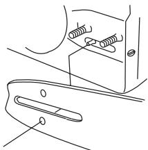
Estique a corrente, apertando com o auxílio da chave universal o parafuso esticador da corrente, no sentido horário. Estique a corrente até que esta deixe de estar frouxa na parte inferior da lâmina. Ver instruções na secção Esticar a corrente da serra.
