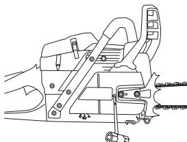
A corrente está correctamente esticada quando não mais estriver frouxa na parte inferior da lâmina e ainda possa ser girada facilmente com a mão. Aperte bem as porcas da lâmina com a chave universal ao mesmo tempo que segura a extremidade da lâmina.
