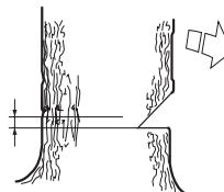
Coloque o apoio para casca (se estiver montado) atrás da linha de ruptura. Serre com aceleração total e deixe a corrente/lâmina penetrar devagar na árvore. Observe se a árvore se move no sentido contrário ao da direcção de queda pretendida. Introduza uma cunha de abate ou barra extractor a profundiade de corte o permita.
