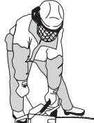
Comprima imediatamente para dentro o estrangulador quando o motor funcionar e faça renovadas tentativas até que o motor arranque. Quando o motor arrancar dê rapidamente aceleração total e a aceleração de arranque é automaticamente desligada.
