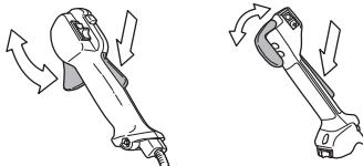
Δείτε τις οδηγίες του κεφαλαίου Εκκίνηση. Βάλτε σε λειτουργία το μηχάνημα και χρησιμοποιήστε πλήρες γκάζι. Αρχίστε το γκάζι και ελέγχετε σάν το εξάρτημα κοπής σταματάει και παραμένει ακινητοποιημένο. Εάν το εξάρτημα κοπής περιστρέφεται με το γκάζι στη θέση ρελαντί, πρέπει να ελεγχθεί η ρύθμιση ρελαντί του καρμπυρατέρ. Δείτε τις οδηγίες του κεφαλαίου Συντήρηση.
