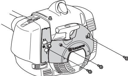
Ξεμοντάρετε το φίλτρο αέρα και το κάπακι φίλτρου αέρα του μηχανήματος. Τοποθετήστε το φίλτρο αέρα και το καπάκι φίλτρου αέρα που περιέχονται στο χειμερινό σετ.
