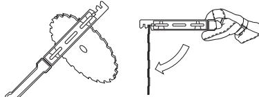
Ελέγχετε το εξάρτημα κοπής για ζημίες ή εμφάνιση ραγισμάτων. Το κατεστραμμένο εξάρτημα κοπής πρέπει πάντα να αντικαθίσταται.
