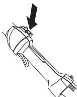
Włącz silnik i sprawdź, czy po przesunięciu wyłącznika w położenie stop silnik zatrzyma się.
