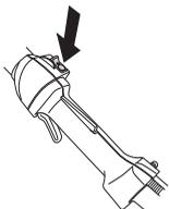
Nastartujte motor a zkontrolujte, zda se motor zastaví při přesunutí vypínače zapalování do vypnuté polohy.
