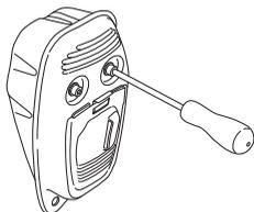
Ak je tlmič výfuku na vašom stroji vybavený zachytávačom iskier, je potrebné ho pravidelne čistiť. Zanesený zachytávač
