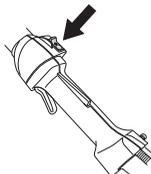
**FIGYELEM!** A stop kapcsoló automatikusan visszatér start állásba. A véletlen beindítás elkerülése érdekében szereléskor, ellenőrzéskor vagy karbantartáskor húzza le a gyertyapipát a gyújtógyertyáról.
