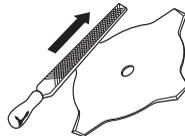
Skontrolujte rezací kotúč, či na ňom nie sú viditeľné známky poškodenia alebo trhliny. Poškodený rezací nástroj treba vždy vymeniť.
