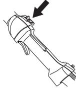
**UWAGA!** Wyłącznik powraca samoczynnie w położenie "start". Dlatego przed przystąpieniem do montażu, kontroli oraz/lub konserwacji należy zawsze zdejmować nasadkę ze świecy zapłonowej w celu zapobieżenia niezamierzonemu uruchomieniu silnika.
