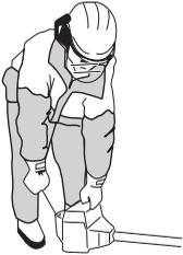
**UWAGA!** Nigdy nie dotykaj żadną częścią ciała do oznaczonej powierzchni. Dotknięcie może spowodować oparzenie ciała lub porażenie prądem, jeżeli nasadka świecy zapłonowej jest uszkodzona. Używaj zawsze rękawic. Nigdy nie używaj maszyny z uszkodzoną nasadką świecy zapłonowej.
