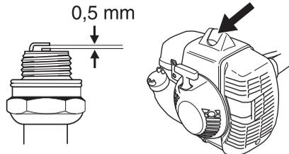
**UWAGA!** Stosuj wyłącznie świece zalecane przez producenta. Niewłaściwa świeca może być przyczyną zatarcia tłoka/cylindra. Dopilnuj, aby świeca zapłonowa była wyposażona w tzw. eliminator zakłóceń radiowych.
