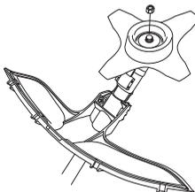
Při montáži utáhněte matici proti směru otáčení řezného vybavení. Při demontáži povolte matici ve směru otáčení
