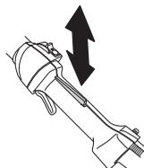
Skontrolujte, či sa páčka plynu a poistná páčka plynu voľne pohybujú a či vratné pružiny náležite fungujú.
