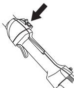
**VAROVÁNÍ!** Vypínač se automaticky vrátí do výchozí polohy. Abyste se při montáži, kontrole a/nebo údržbě vyhnuli nezamýšlenému nastartování je nutno vždy odejmout rozbušku od zapalovací svíčky.
