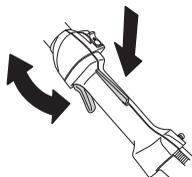
Lásd az Indítás című fejezetet. Kapcsolja be a gépet és adjon teljes gázt. Engedje el a gázszabályozót és győződjön meg róla, hogy a vágófelszerelés leállt és teljesen mozdulatlan. Ha a vágószerszám alapjáratban is forog, ellenőrizze a porlasztó alapjáratának beállítását. Lásd a Karbantartás című fejezetben szereplő utasításokat.
