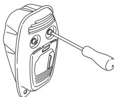
Jeśli tłumik w Twojej maszynie jest wyposażony w siatkę przeciwwiskrową, należy ją regularnie czyścić.
