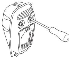
Pokud je tlumič výfuku na stroji vybaven lapačem jisker, musí se sítka lapače pravidelně čistit. Ucpané sítka lapače způsobuje přehřátí motoru a může vést k vážnému poškození stroje.
