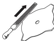
Kontrolujte řezné vybavení co do poškození a vzniku trhlinek. Poškozené řezné vybavení je nutné vždy vyměnit.
