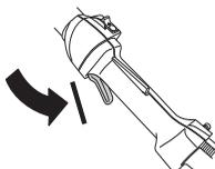
Stiskněte pojistku páčky plynu a zkontrolujte, zda se po uvolnění vrátí do své výchozí polohy.
