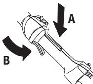
Sprawdź, czy dźwignia gazu jest zablokowana w położeniu biegu jałowego, gdy blokada dźwigni gazu znajduje się w położeniu wyjściowym.
