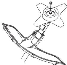
Összeszerelésnél a csavaranyát a vágófelszerelés forgásával ellentétes irányban csavarva húzza meg. Szétszerelésnél a csavaranyát a vágófelszerelés forgásának megfelelő irányban csavarva húzza meg. (FIGYELEM! A csavar balmenetes.) Húzza meg az anyát csókulcs segítségével.
