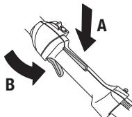
Presvedčte sa, či je ovládanie plynu zablokované pri nastavení na voľnobeh, keď je poistná páčka plynu uvoľnená.
