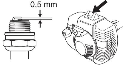
**FIGYELEM!** Használja mindig az előírt típusú gyújtógyertyát! Nem megfelelő gyújtógyertya komolyan károsíthatja a henger és a dugattyút. A gyújtógyertya olyan legyen, amely a rádióadást nem zavarja.
