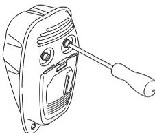
Ha az Ön gépén a kipufogódob szikrafogó hálósval rendelkezik, akkor azt rendszeresen tisztítani kell. Eltömődött háló a motor túlmelegedését okozza, ami a motor komoly károsodásához vezethet.
