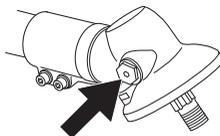
Z reguły nie trzeba wymieniać smaru w obudowie przekładni częściej niż przy okazji ewentualnej naprawy.
