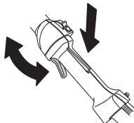
Patrz wskazówki pod rubryką Uruchamianie. Włącz maszynę i dodaj gazu do oporu. Zwolnij dźwignię gazu i sprawdź, czy osprzęt tnący zatrzymał się i nie porusza się. Jeśli osprzęt tnący obraca się, mimo iż dźwignia gazu znajduje się w położeniu biegu jałowego, należy sprawdzić wyregulowanie biegu jałowego gaźnika. Patrz wskazówki pod rubryką Konserwacja.
