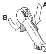
Compruebe que el acelerador esté bloqueado en la posición de ralentí cuando el fiador está en su posición inicial.
