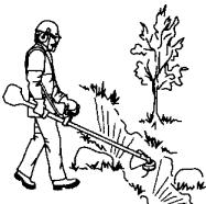
4. Înainte de deplasare trebuie să opriți motorul. La deplasări mai lungi că și la transport trebuie folosită protecția la transport.
