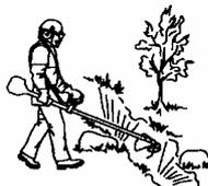
4. Выключайте двигатель, когда переходите на другой участок. Наденьте защиту ножа при транспортировке на режущий орган прежде, чем переносить машину на любое расстояние.
