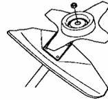
Во время сборки затягивайте гайку в сторону, противоположную направлению вращения режущих органов. При снятии режущего органа откручивайте гайку в направлении, совпадающем с направлением движения режущих органов.
