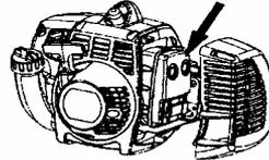
Зاغлушителят е предназначен да осигури най-ниското ниво на шума и да насочва изпускания от машината дим в посока, обратна на оператора. Отработилите газове на мотора са горещи и могат да съдържат искри, които да доведат до избухване на пожар, когато са насочени към запалително вещество. Заглушителите са снабдени със специална мрежа за спиране на искрите. Мрежата трябва да се провери и, ако е необходимо, да се почисти от сервиза. **Ако мрежата е повредена, трябва да се смени.**
