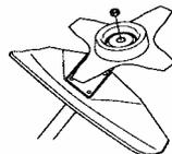
При поставяне затегнете гайката в обратна посока на посоката на въртене на приспособлението за рязане. За да свалите гайката, я развийте в същата посока, в която се върти режещото приспособление.
