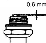
**ЗАБЕЛЕЖКА!** Винаги използвайте свещ от препоръчвания тип! Използването на свещ от неправилен тип може да повреди буталото/цилиндъра.
