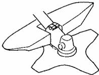
Убедитесь в том, что защита не имеет повреждений и трещин. Замените защиту, если она подверглась ударам или треснула. Всегда используйте защиту, рекомендованную для того типа режущих органов (насадок), который вы используете. См. раздел "Технические характеристики".
