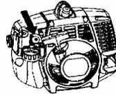
**Дросел:** Превключете синьото лостче на дросела на мотора в затворено положение.
