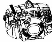
**Воздушная заслонка:** Переведите синий рычаг воздушной заслонки двигателя в закрытое положение.
