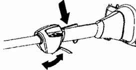
Убедитесь, что рычаг и стопор рычага дросселя легко двигаются и их возвратные пружинные механизмы работают исправно. См. раздел "Запуск". Запустите машину и полностью откройте дроссель. Отпустите рычаг дросселя и убедитесь, что режущие органы останавливаются и остаются неподвижными. Если режущие органы продолжают вращаться при дросселе в режиме холостого хода, необходимо отрегулировать карбюратор в режиме холостого хода. См. раздел "Техобслуживание".
