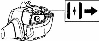
**ПРИМЕЧАНИЕ:** Если двигатель глохнет, верните синий рычаг воздушной заслонки двигателя в закрытое положение и повторите все сначала.
