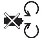
Cuchillas giratorias No introduzca nunca una mano ni un pie bajo la cubierta mientras esté en marcha el motor
