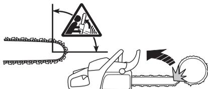
O retrocesso desloca-se sempre na direcção do plano da lâmina. Mais comum é que a moto-serra e a lâmina sejam arremessadas para cima e para trás, contra o utilizador. Entretanto, ocorrem outras direcções de retrocesso, dependendo da posição da moto-serra no momento em que o sector de risco de retrocesso a lâmina entrou em contacto com um objecto.
