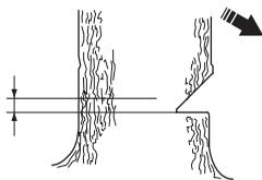
Coloque o apoio para casca (se estiver montado) atrás da linha de ruptura. Serre com aceleração total e deixa a corrente/lâmina penetrar devagar na árvore. Observe se a árvore se move no sentido contrário ao da direcção de queda pretendida. Introduza uma cunha de abate ou
