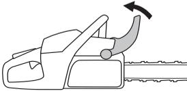
Desenrosque las tuercas de la espada y saque la cubierta del embrague (el freno de cadena). Saque la protección de transporte (A).
