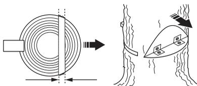
Perde-se todo o controlo sobre a direcção de queda da árvore se a linha de ruptura for demasiado pequena ou muito serrada, ou se o corte direccional e o corte de abate estiverem incorretamente posicionados.
