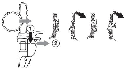
La profundidad del corte de indicación debe ser igual a  $\frac{1}{4}$  del diámetro del tronco, y el ángulo entre los cortes superior e inferior debe ser de  $45^\circ$  como mínimo.
