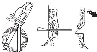
El corte de derribo debe quedar paralelo con la línea de corte de indicación, con una distancia mínima entre ambos de  $\frac{1}{10}$  del diámetro del tronco. La parte del tronco sin cortar se denomina faja de desgaje.
