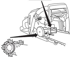
Verifique se o fio dos elos de corte está voltado para a frente, na parte superior da lâmina.
