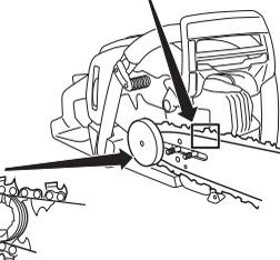
Compruebe que los filos de los eslabones de corte estén orientados hacia delante en la parte superior de la espada.
