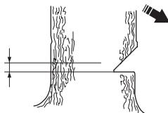
Coloque el apoyo de corteza (si ha sido montado) detrás de la faja de desgaje. Corte con aceleración máxima introduciendo lentamente la cadena/espada en el tronco. Preste atención a si el árbol se mueve en dirección opuesta a la elegida para el derribo. Tan pronto lo permita
