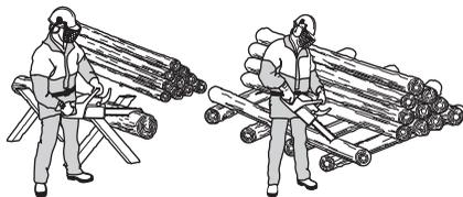
**O tronco está deitado sobre o solo.** Não há nenhum risco da corrente se prender ou de fendilhamento do objecto a serrar. O risco é, entretanto, grande de que a corrente toque o solo após a serração de fora a fora.
