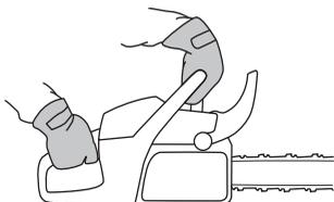
Acelere al máximo y active el freno de cadena girando la muñeca izquierda hacia la protección contra reculadas. No suelte el mango delantero. **La cadena debe detenerse inmediatamente.**
