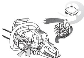
**IMPORTANTE!** Para conservar a função de purificação centrífuga, é necessário prestar assistência e manutenção contínuas. Limpe a entrada de ar do dispositivo de arranque, asas de ventoinha da cambota,
