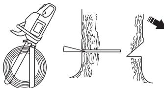
O corte de abate deverá terminar paralelamente à linha de corte direccional de modo que a distância entre ambos seja no mínimo de 1/10 do diâmetro do tronco. A parte não serrada no tronco é designada de linha de ruptura.
