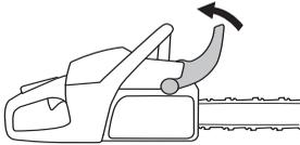
Desatarraxe inteiramente as porcas e remova a cobertura de acoplamento (travão de corrente). Retire o protector para transporte (A).
