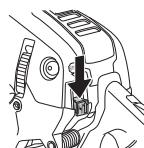
El motor se arranca presionando el mando de arranque/parada.
