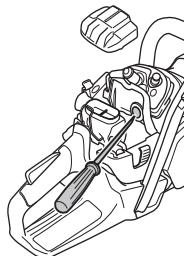
Para temperaturas abaixo dos -5°C e/ou condições de queda de neve, existe disponível uma cobertura especial que se monta na caixa do dispositivo de arranque.
