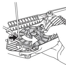
Retire el enganche del centro de la polea. Desmonte el separador y la polea. Ponga un cordón de arranque nuevo en la polea y fíjelo. Enrolle unas 3 vueltas de cordón de arranque en la polea. Monte la polea contra el muelle de retorno de forma que el muelle enganche la polea. Acople el separador y fije la polea con el enganche. Pase el cordón por el orificio del cuerpo del
