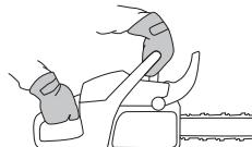
Acelere ao máximo e active o travão de corrente, virando o pulso esquerdo contra a protecção anti-retrocesso. Não solte o punho dianteiro. **A corrente deverá parar imediatamente.**
