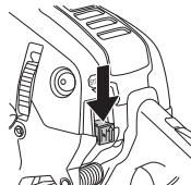
¡ATENCIÓN! El contacto de arranque/parada retorna automáticamente a la posición de marcha. Por consiguiente, para evitar el arranque involuntario hay que quitar siempre el capuchón de encendido de la bujía antes de realizar trabajos de montaje, control y/o mantenimiento.
