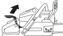
Mueva el freno de la mano derecha hacia delante/arriba para controlar que se mueve fácilmente y que está bien afianzado en su articulación en el envolvente del embrague.
