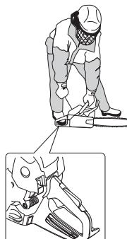
Dado que el freno de cadena todavía está activado, se deben bajar las revoluciones del motor lo antes posible a ralenti, y esto se logra desconectando rápidamente el
