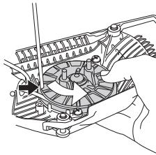
Retire o clipe no centro do carretel. Retire o espaçador e o carretel. Introduza e aperte uma nova corda de arranque no carretel. Enrole cerca de 3 voltas da corda de arranque no carretel. Ligue o carretel à mola de retorno de modo a que a mola engate no carretel. Ajuste o espaçador e fixe o carretel com o clipe. Introduza a corda de arranque nos orifícios da caixa do dispositivo de arranque e do punho de arranque. Depois disso dê um nó forte na corda de arranque.
