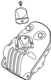
O silenciador é configurado para abafar o nível de ruído e para conduzir os gases de escape para longe do utilizador. Os gase de escape são quentes e podem conter faíscas que podem causar incêndios, se os gases forem dirigidos contra um material seco e inflamável.
