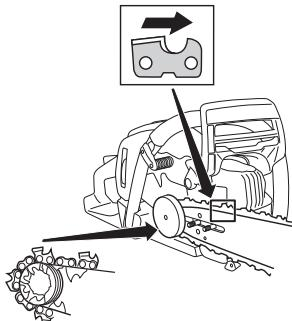
Compruebe que los filos de los eslabones de corte estén orientados hacia delante en la parte superior de la espada.
