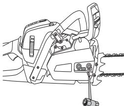
A corrente está correctamente esticada quando não mais estriver frouxa na parte inferior da lâmina e ainda possa ser girada facilmente com a mão. Aperte bem as porcas da lâmina com a chave universal ao mesmo tempo que segura a extremidade da lâmina.
