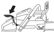
**Nunca transporte nem suspenda a serra pelo arco! Isso pode danificar o mecanismo e pôr o travão da corrente fora de função.**
