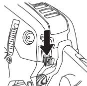
NOTA! O interruptor de Arranque/Paragem retorna automaticamente à posição de operação. Por isso, para impedir o arranque acidental da máquina, deve-se sempre remover a protecção da vela de ignição durante todos os trabalhos de montagem, inspecção e/ou manutenção.
