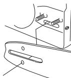
Estique a corrente, apertando com o auxílio da chave universal ou parafuso esticador da corrente, no sentido horário. Estique a corrente até que esta deixe de estar frouxa na parte inferior da lâmina. Ver instruções na secção Esticar a corrente da serra.
