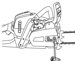
La cadena está correctamente tensada cuando no cuelga en la parte inferior de la espada y puede girarse fácilmente con la mano. Apriete las tuercas de la espada con la llave combinada, sujetando al mismo tiempo la punta de la espada.
