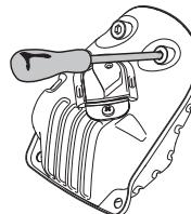
Neki prigušivači zvuka su opremljeni sa posebnom mrežicom koja gasi iskrice. Ako je u tvoja mašina opremljena jednim takvim prigušivačem zvuka treba mrežicu očistiti jednom sedmично a najbolje je čistiti sa čeličnom četkom. Blokirana mreža može izazvati da se motor pregrije i tako dovede do ozbiljnog oštećenja.
