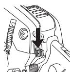
Motor zaustavite pritiskom na prekidač za pokretanje/zaustavljanje.
