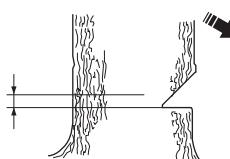
Postavi odbojnik (ako je namontiran) iza pojasa lomljena. Pilaj sa punim gasom i uvedi mač pile polako u stablo. Budi pažljiv ako se drvo pokreće u suprotnom pravcu od izabranog pravca padanja. Stavi klin u rez koliko dubina reza dozvoljava.
