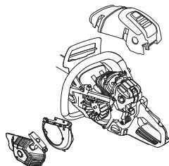
Čist rashladni sistem četkom jedanput sedmično ili češće po potrebi. Nečist ili začepljen rashladni sistem prouzrokuje pregrijavanje mašine i oštećenja cilindra i klipa.
