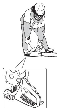
Pošto je kočnica lanca i dalje aktivirana mora se ubrzano broj obrta motora spustiti na prazan hod, što se postiže na taj način da se iskopča zapreka gasa. Sa ovim izbjegavate nepotrebno habanje kvačila, bubnja kvačila kao i kaiša za kočenje.
