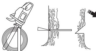
Oborni rez treba da završava paralelno sa linijom pravca rezanja i da je razdaljina između njih najmanje  $1/10$  od prečnika stabla. Taj neispilan dio se zove slomljeni mjesec.
