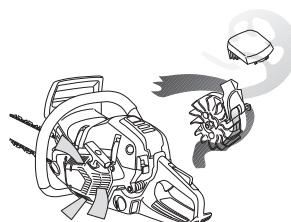
**VAŽNO!** Za trajno djelovanje centrifugalnog čišćenja potrebni su stalno održavanje i briga. Očisti ulaz zraka u starter, elise zamajca, prostor oko zamajca, ulaznu cijev i karburatorski prostor.
