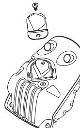
Prigušivač zvuka je izrađen da priguši jačinu zvuka i da odvodi izduvne gasove od rukovaoca. Izduvni gasovi su vruci i iskričavi
