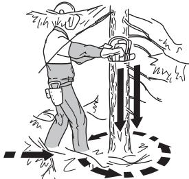
Očistiti okolo drveta od vegetacije i eventualnih prepreka (kamenje, granje, rupe itd.) tako da imaš lako dostupan put kada drvo počne padati. Put unazad treba da bude u kosom pravcu  $135^{\circ}$  unazad od planiranog pada drveta.
