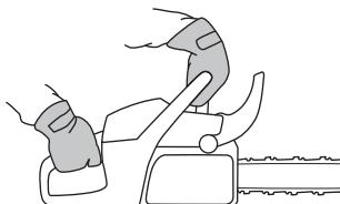
Daj puni gas i aktiviraj kočnicu lanca tako da okreće lijevi ručni zglob prema štitniku trzaja. Ne puštaj prednji rukohvat. **Lanac se odmah zaustavlja.**
