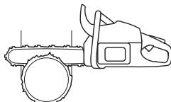
Postoji i metoda rezanja onog stabla koje ima veći prečnik od dužine mača pile. Kod takvih metoda postoji veći rizik da rizično područje mača dode u kontakt sa nekim predmetom.
