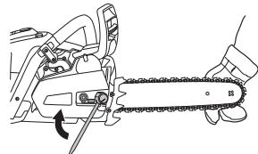
Na novom lancu se moraju vršiti češće kontrole zategnutosti često dok se lanac uhoda. Dobar lanac daje veći učinak rezanja i dužinu trajanja.
