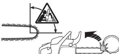
Kada se pila sa donjom stranom mača tj. sa gornje strane predmeta koji se pila prema dole to se naziva povlačenje lana pile. Tada se povlači motorna pila prema drvetu i prednji kraj tijela motorne pile postaje prirodni oslonac prema deblu. Pilanje sa povlačenjem lana pile daje rukovaocu bolju kontrolu nad motornom pilom i nad položajem gdje se nalazi rizično područje mača.
