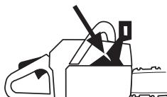
フロントハンドガードを前後に動かしてみて、スムーズに動くか、クラッチカバーで確実に止まるかなどを点検します。
