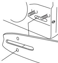
コンビレンチを用いて調整ネジを時計方向に回して締め、チェンを張ります。チェンがガイドバーの下側でたるまなくなるまで締めてください。
