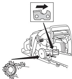
カッターリンクの刃がガイドバーの上側で前向きになっていることを確認します。
