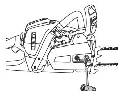
ガイドバーの下側にたるみがなく、しかもチェンは手で自由に回せる程度になつたら、チェンは正しく張っています。ガイドバーの先端を持ち上げ、コンビレンチでバーナットを締め込みます。
