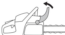
バーナットとクラッチカバー(チェンブレーキ)を取り外します。輸送リング(A)も取り外します。
