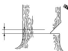
つるの後ろ側にスパイク(装備されている場合)を当てます。フルスロットルでチェンとガイドバーをゆっくりと押し進めます。倒す方向の反対側に木が傾き始めないと確認してください。切り口が十分深くなったら、直ちにクサビかフェリングレバーを差し込みます。
