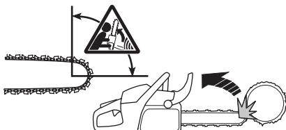
キックバックは、常にガイドバーの鋸断面で起こります。通常、チェンソーがガイドバーを先にして、使用者の方に斜め上にはじき返されます。ただし、キックバックゾーンが何かに触れたときのチェンソーの使い方により、異なる方向にはじき返されることもあります。
