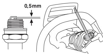
注記! 必ず指定のタイプのスパークプラグを使用してください! 不適正なスパークプラグは、ピストンやシリンダーの損傷の原因となります。スパークプラグがサブレッサーに正しく装着していることを確認します。
