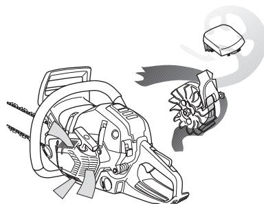
なメンテナンスが必要です。スターター装置の吸気口、フライホイールのファン、フライホイール周辺のスペース、インレットパイプ、およびキャブレタユニットを清掃してください。
