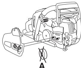
ガイドバーをバーボルトにはめます。バーを一番後方へスライドさせます。チェンをドライブスプロケットとガイドバーのレール溝に装着します。ガイドバーの上側から装着作業を始めてください。
