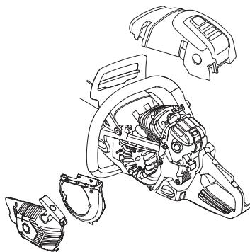
冷却システムをブラシで週に一度、過酷な使用環境ではより頻繁に清掃してください。冷却システムが汚れたり詰まつたりしているとチェンソーがオーバーヒートを起こし、ピストンやシリンダーの損傷の原因となります。
