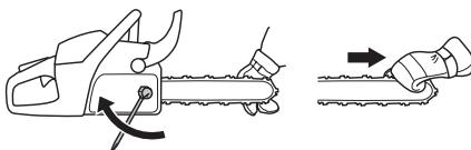
チェンの張り調整ネジの位置は、チェンソーのモデルによって異なります。お持ちのチェンソーの調整ネジの位置を「各部名称」でご確認ください。
