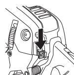
注意!スタート/ストップスイッチが、自動的に始動位置に戻ります。組み立て、点検、メンテナンスを行うときは、意図しない始動を防止するため、スパークプラグキャップがスパークプラグから外される必要があります。
