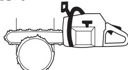
ガイドバーより幹の直径が長いときの伐倒方法もあります。が、ガイドバーのキックバックゾーンが木に接触する危険性が非常に高くなります。
