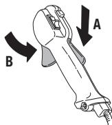
Zkontrolujte, zda při uvolnění pojistky páčky plynu zapadne páčka plynu do polohy, při které je motor ve volnoběžných otáčkách.
