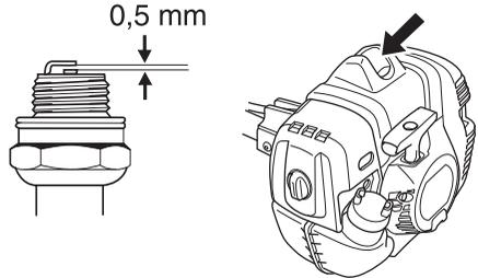
**UPOZORNENIE!** Vždy používajte odporúčaný typ zapaľovacej sviečky! Nesprávna zapaľovacia sviečka môže vážne poškodiť piest/valec.
