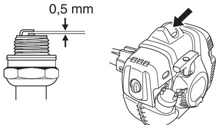
**FIGYELEM!** Használja mindig az előírt típusú gyújtógyertyát! Nem megfelelő gyújtógyertya komolyan károsíthatja a hengert és a dugattyút.
