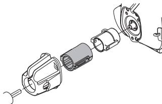
Ellenőrizze rendszeresen a rezgéscsillapító elemeket, repedések és torzulások szempontjából.
