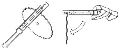
Skontrolujte rezací kotúč, či na ňom nie sú viditeľné známky poškodenia alebo trhliny. Poškodený rezací nástroj treba vždy vymeniť.
