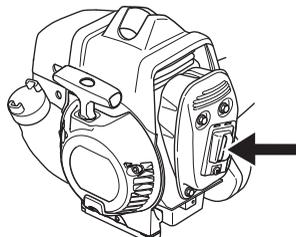
Některé tlumiče výfuku jsou vybaveny speciálním sítkovým lapačem jisker. Pokud vaše zařízení je opatřeno takovým
