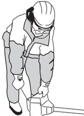
**UPOZORNENIE!** Nevstupujte žiadnou časťou tela do vyznačeného priestoru. Kontakt môže mať za následok popálenie pokožky alebo elektrický šok, ak je kryt zapalovacej sviečky poškodený. Vždy používajte rukavice. Nepoužívajte stroj s poškodeným krytom zapalovacej sviečky.
