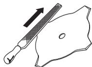
Udržujte řezací kotouč správně natočený! Sledujte naše instrukce a používejte doporučený nástroj k natočení. Nesprávně natočený řezací kotouč zvyšuje riziko uvážnutí kotouče a zpětného odrazu.
