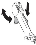
Vyhľadajte si inštrukcie v odseku Štart. Naštartujte stroj a pridajte na plný plyn. Uberte plyn a skontrolujte, či sa rezačí nástroj zastavil a či potom zostal stáť. Pokiaľ rezačí nástroj rotuje aj pri chode stroja na voľnobeh, potom treba
