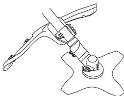
Sprawdź, czy osłona nie jest uszkodzona i czy nie ma śladów pęknięcia. Wymień osłonę, która została uderzona lub jest pęknięta.
