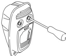
Ak je tlmič výfuku na vašom stroji vybavený zachytávačom iskier, je potrebné ho pravidelne čistiť. Zanesený zachytávač spôsobí prehriatie motora a môže zapríčiniť jeho vážne poškodenie.
