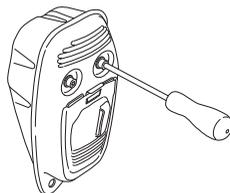
Jeśli tłumik w Twojej maszynie jest wyposażony w siatkę przeciwwiskrową, należy ją regularnie czyścić.
