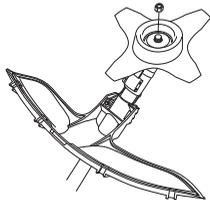
Összeszerelésnél a csavaranyát a vágófelszerelés forgásával ellentétes irányban csavarva húzza meg. Szétszerelésnél a csavaranyát a vágófelszerelés forgásának megfelelő irányban csavarva húzza meg. (FIGYELEM! A csavar balmenetes.) Húzza meg az anyát csőkulcs segítségével.
