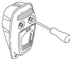
Pokud je tlumič výfuku na stroji vybaven lapačem jisker, musí se sítko lapače pravidelně čistit. Ucpané sítko lapače způsobuje přehřátí motoru a může vést k vážnému poškození stroje.
