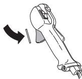
Stiskněte pojistku páčky plynu a zkontrolujte, zda se po uvolnění vrátí do své výchozí polohy.
