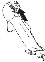
**VAROVÁNÍ!** Vypínač se automaticky vrátí do výchozí polohy. Abyste se při montáži, kontrole a/nebo údržbě vyhnuli nezamýšlenému nastartování je nutno vždy odejmout rozbušku od zapalovací svíčky.
