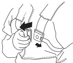
Sprawdź, czy paski szelek są właściwie umieszczone. Po wyregulowaniu szelek i zawieszania maszyny sprawdź, czy działa mechanizm rozpinania awaryjnego.
