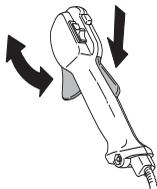
Patrz wskazówki pod rubryką Uruchamianie. Włącz maszynę i dodaj gazu do oporu. Zwolnij dźwignię gazu i sprawdź, czy osprzęt tnący zatrzymał się i nie porusza się. Jeśli osprzęt tnący obraca się, mimo iż dźwignia gazu znajduje się w położeniu biegu jałowego, należy sprawdzić wyregulowanie biegu jałowego gaźnika. Patrz wskazówki pod rubryką Konserwacja.
