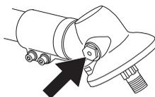
Z reguły nie trzeba wymieniać smaru w obudowie przekładni częściej niż przy okazji ewentualnej naprawy.
