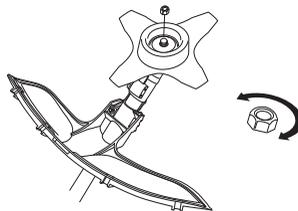
Nylonowy pierścień zabezpieczający nakrętkę przed odłączeniem się nie powinien być starty do tego stopnia, aby można było przykręcić nakrętkę ręcznie. Zabezpieczenie to powinno wymagać siły przykręcania równej co najmniej 1,5 Nm. Po około dziesięciokrotnym przykręcaniu nakrętki należy wymienić ją na nową.
