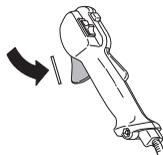
Wciśnij blokadę dźwigni gazu i sprawdź, czy po zwolnieniu nacisku powraca ona do położenia wyjściowego.
