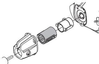
Pravidelně kontrolujte, zda se na blocích antivibračního systému neobjevují trhliny či deformace.
