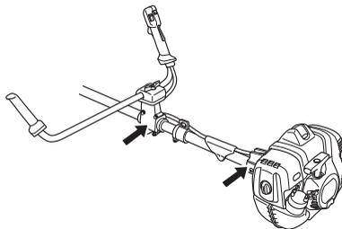
Helytelenül bevont huzal illetve élezetlen, nem megfelelő (eltérő típusú vagy helytelenül élezett, lásd a Pengeélezés című fejezetben szereplő utasításokat) vágófelszerelés használata emeli a rezgésszintet.
