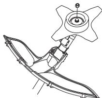
Při montáži utáhněte matici proti směru otáčení řezného vybavení. Při demontáži povolte matici ve směru otáčení řezného vybavení. (POZOR! Matice je levotočivá.) Dotáhněte matici pomocí nástrčného klíče.
