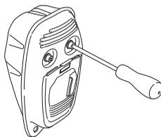
Ha az Ön gépén a kipufogódob szikrafogó hálával rendelkezik, akkor azt rendszeresen tisztítani kell. Eltömődött háló a motor túlmelegedését okozza, ami a motor komoly károsodásához vezethet.
