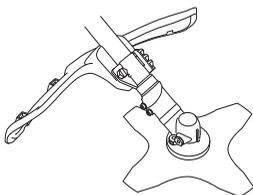
Zkontrolujte, zda kryt není poškozen ani nemá trhlinky. Byl-li kryt vystaven úderu nebo má trhlinky je nutno jej vyměnit.
