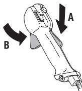
Presvedčte sa, či je ovládanie plynu zablokované pri nastavení na voľnobeh, keď je poistná páčka plynu uvoľnená.
