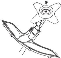
Podczas montażu dokręcaj nakrętkę w kierunku przeciwnym do kierunku obrotów osprzętu tnącego. Podczas demontażu odkręcaj nakrętkę w kierunku zgodnym z kierunkiem obrotów
