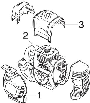
Chladicí systém se skládá z následujících součástí:
