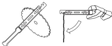
Skontroluj, czy narzędzia tnące nie są uszkodzone bądź pęknięte. Uszkodzone narzędzia tnące należy wymienić na nowe.
