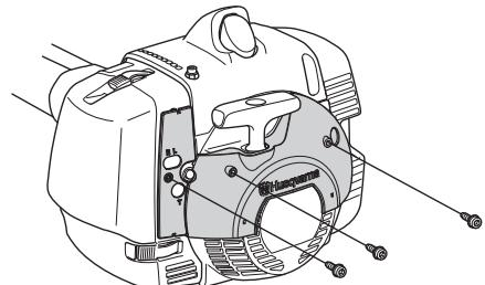
Ota koneen ilmansuodatin ja ilmansuodattimen kansi pois. Asenna talvisarjan mukana toimitettu ilmansuodatin ja ilmansuodattimen kansi.
