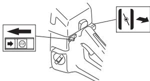
Если машина оборудована декомпрессионным клапаном (А): Его необходимо нажать, чтобы уменьшить давление в цилиндре и облегчить запуск машины. При запуске машины всегда пользуйтесь декомпрессионным клапаном.
