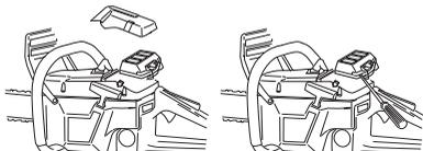
Для более тщательной чистки фильтр следует помыть в воде с мылом.
