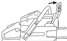
**Зажигание:** Установите переключатель зажигания в левое положение.
