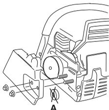
Установите пильное полотно на специально предназначенные болты. Установите полотно в самое заднее положение. Наденьте цепь на ведущую звездочку и вставьте ее хвостовики в паз пильного полотна. Начинайте с верхней стороны пильного полотна.
