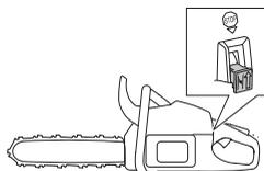
**NOTA!** O interruptor de Arranque/Paragem retorna automaticamente à posição de operação. Por isso, para impedir arranque acidental, deve-se sempre remover o cachimbo da vela de ignição quando a máquina não está sob vigilância.
