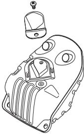
O silenciador é configurado para abafar o nível de ruído e para conduzir os gases de escape para longe do utilizador. Os gases de escape são quentes e podem conter faíscas que podem causar incêndios, se os gases forem dirigidos contra um material seco e inflamável.
