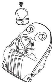
**NOTA!** O silenciador fica muito quente tanto durante o funcionamento como após se desligar a máquina. Isto aplica-se também quando a motosserra na marcha em vazio. Esteja consciente do perigo de incêndio, especialmente ao manusear substâncias inflamáveis e/ou gases.
