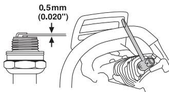
Aclaración! ¡Utilice siempre el tipo de bujía recomendado! Una bujía incorrecta puede arruinar el pistón y el cilindro. Asegúrese de que la bujía tenga supresión de perturbaciones radioeléctricas.
