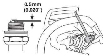
Observe! Use sempre o tipo de vela de ignição recomendado! Uma vela de ignição incorrecta pode danificar o pistão/cilindro. Verifique se a vela de ignição não produz interferências de rádio.
