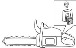
NOTA! O interruptor de Arranque/Paragem retorna automaticamente à posição de operação. Por isso, para impedir o arranque accidental da máquina, deve-se sempre remover a protecção da vela de ignição durante todos os trabalhos de montagem, inspecção e/ou manutenção.
