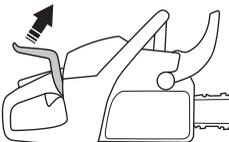
**Nunca transporte nem suspenda a serra pelo arco! Isso pode danificar o mecanismo e pôr o travão da corrente fora de função.**
