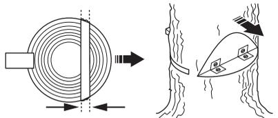
Se pierde completamente el control de la dirección de derribo del árbol si la faja de desgaje es demasiado
