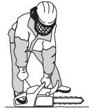
Cuando el motor arranque, oirá una especie de soplido y entonces deberá **oprimir inmediatamente el estrangulador rojo**. Reponga con firmeza el cordón a su posición inicial y repita el intento hasta que el motor arranque.
