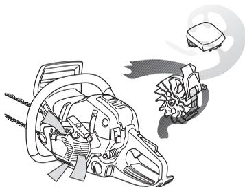
**IMPORTANTE!** Para conservar a função de purificação centrífuga, é necessário prestar assistência e manutenção contínuas. Limpe a entrada de ar do dispositivo de arranque, asas de ventoinha da cambota, compartimento em torno da cambota, tubo de admissão e compartimento do carburador.
