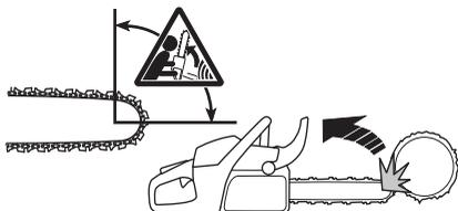
O retrocesso desloca-se sempre na direcção do plano da lâmina. Mais comum é que a moto-serra e a lâmina sejam arremessadas para cima e para trás, contra o utilizador. Entretanto, ocorrem outras direcções de retrocesso, dependendo da posição da moto-serra no momento em
