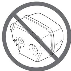
定期检查消音器是否牢固安装在机器上。
