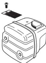
消音器的设计是用于降低噪音，同时将引擎的废气导离操作者。引擎的废气很热烫，有时会激发火花，如果溅向干燥易燃的材料，可能会引起火灾。
