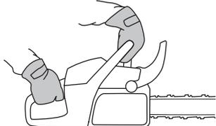
全开油门，并通过将您的左腕向前倾斜至前护手板的方式启用链制动器。切勿松开前侧把手。锯链应立即停止。
