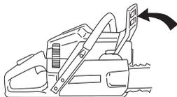
旋下轮杆螺母，拆下离合器罩（链制动器）。拆下运输环 (A)。
