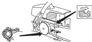
确保切割链边缘在导板顶部边缘上面朝前方。
