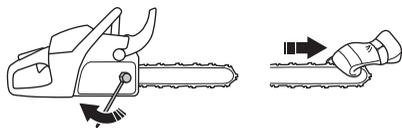
Положението на винта за натягане на триона варира в зависимост от моделите на моторни триони. Вижте инструкциите в раздела Ко е какво е, за да откриете къде се намира той при вашия модел.
