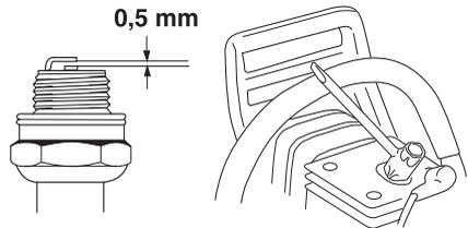
**ЗАБЕЛЕЖКА!** Използвайте винаги запалителните свещи от препоръчания вид! Използването на погрешен тип свещи може да предизвика сериозни повреди на буталото/цилиндъра. Убедете се, че запалителната свещ е снабдена със защита от радиосмущения.
