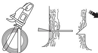
Повалещият срез трябва да завърши успоредно на линията на направляващия срез, като разстоянието помежду им трябва да бъде най-малко 1/10 от диаметъра на стъблото. Несрязаната част на дървото се нарича предпазна ивица.
