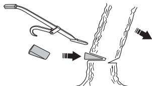
Препоръчваме ви да използвате шина, която е по-дълга от диаметъра на дървото, така че да можете да правите основния срез и насочващите срезове с "единични режещи движения". Вижте инструкциите в раздела със заглавието Технически данни относно кои дължини на шината се препоръчват за вашия модел моторен трион.
