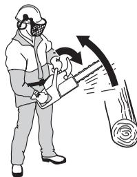
При по-слаб тласък или ако рисковият сектор на тласъка на шината се намира близо до оператора, верижната спирачка се включва ръчно с лявата ръка.
