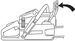
Отвинтете гайките на шината и свалете капака на съединителя. Свалете защитата за транспортиране (А).
