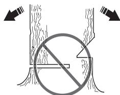
След завършване на повалящия срез и направляващия срез дървото трябва да започне да пада под въздействието на собствената си тежест или с помощта на клин или лост.
