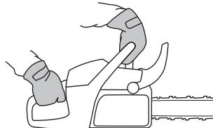
Acelere ao máximo e active o travão de corrente, virando o pulso esquerdo contra a protecção anti-retrocesso. Não
