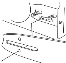
Estique a corrente, apertando com o auxílio da chave universal o parafuso esticador da corrente, no sentido horário. Estique a corrente até que esta deixe de estar frouxa na parte inferior da lâmina. Ver instruções na secção Esticar a corrente da serra.
