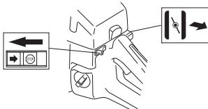
Se a máquina estiver equipada com uma válvula descompressora (A): Comprima a válvula para diminuir a pressão no cilindro, o que facilita o arranque da máquina. A válvula descompressora deve usar-se sempre no arranque. Quando a máquina arranca, a válvula retorna automaticamente à posição original.
