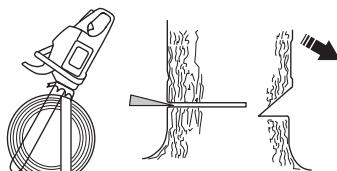
El corte de derribo debe quedar paralelo con la línea de corte de indicación, con una distancia mínima entre
