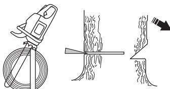
O corte de abate deverá terminar paralelamente à linha de corte direccional de modo que a distância entre ambos
