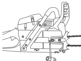
A corrente está correctamente esticada quando não mais estiver frouxa na parte inferior da lâmina e ainda possa ser girada facilmente com a mão. Aperte bem as porcas da lâmina com a chave universal ao mesmo tempo que segura a extremidade da lâmina.
