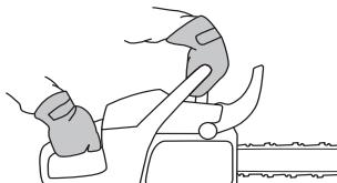
Acelere al máximo y active el freno de cadena girando la muñeca izquierda hacia la protección contra reculadas.
