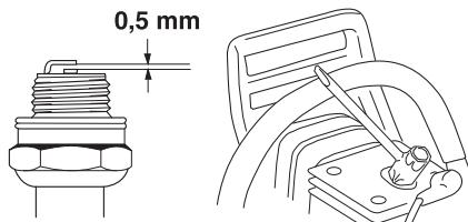
Observe! Use sempre o tipo de vela de ignição recomendado! Uma vela de ignição incorrecta pode danificar o pistão/cilindro. Verifique se a vela de ignição não produz interferências de rádio.
