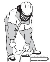
Segure a moto-serra numa posição firme, com os polegares e dedos à volta do punho.
