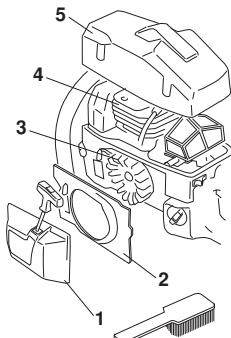
Lime o sistema de arrefecimento com uma escova, uma vez por semana, ou com mais frequência, em condições de trabalho difíceis. O sistema de arrefecimento obstruído ou sujo conduz a um sobreaquecimento da máquina, danificando o cilindro e o pistão.
