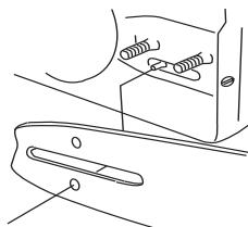
Tense la cadena enroscando en sentido de las agujas del reloj el tornillo de tensado con la llave combinada. La cadena debe tensarse hasta que deje de colgar en la parte inferior de la espada. Vea las instrucciones del capítulo Tensado de la cadena de sierra.
