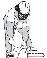
Comprima imediatamente para dentro o estrangulador quando o motor funcionar e faça renovadas tentativas até que o motor arranque. Quando o motor arrancar dê rapidamente aceleração total e a aceleração de arranque é automaticamente desligada.
