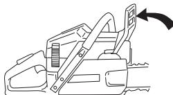
Desrosque las tuercas de la espada y saque la cubierta del embrague (el freno de cadena). Saque la protección de transporte (A).
