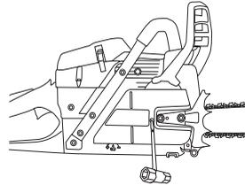
La tensione è corretta quando la catena rimane nella scanalatura intorno alla lama ed è possibile farla scorrere con le dita, senza sforzo. Serrare a fondo i dadi con la chiave combinata tenendo sollevata la punta della lama.
