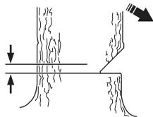
Inserire l'appoggio per la corteccia dietro il fulcro (se è stato montato l'apposito dispositivo). Lavorare a pieno gas e far avanzare la catena/lama lentamente nel tronco. Controllare che l'albero non si muova in direzione opposta
