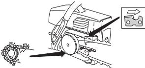
Controllare che il taglio dei denti sia rivolto in avanti, sul lato superiore della lama.
