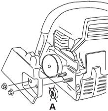
Montare la lama sui perni di fissaggio. Spingere la lama indietro al massimo. Sistemare la catena sopra la ruota motrice e farla passare nella scanalatura. Cominciare dalla parte superiore.
