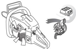
**IMPORTANTE!** Per mantenere sempre un livello ottimale di funzionamento della depurazione centrifuga, il sistema va pulito agli intervalli indicati. Pulire la presa dell'aria sul dispositivo di avviamento, le alette del volano, lo spazio intorno al volano, il condotto di aspirazione e il vano del carburatore.
