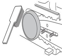
Controllare con regolarità che la fascia frenante abbia almeno uno spessore di 0,6 mm nel punto di maggiore usura.
