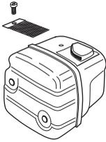
La marmitta è dimensionata in modo da diminuire la rumorosità e per allontanare i gas di scarico dall'operatore. I gas di scarico sono caldi e possono contenere scintille, pericolose in presenza di materiale infiammabile.
