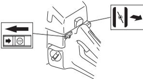
Se la macchina è dotata di valvola di decompressione (A): premere sulla valvola per diminuire la compressione nel cilindro e facilitare la messa in moto. Usare sempre la valvola di decompressione durante la messa in moto. Quando il motore è in moto la valvola torna automaticamente nella posizione iniziale.
