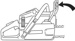
Svitare i dadi della lama, togliendo anche il coperchio della frizione (freno della catena). Eliminare la protezione per il trasporto (A).
