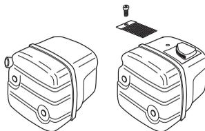
**N.B!** La marmitta è molto calda durante l'uso e per un po' di tempo dopo. Quanto detto vale anche se la macchina funziona al minimo. Considerare il pericolo di incendio, specialmente quando si movimentano sostanze e/o gas infiammabili.
