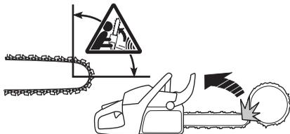
Il contraccolpo avviene sempre lungo il piano di taglio della lama. Di solito il movimento di motosega e lama è verso l'alto e verso l'operatore. Possono tuttavia verificarsi altre situazioni a seconda della posizione della motosega nel momento in cui il settore a rischio viene a contatto con un corpo estraneo.
