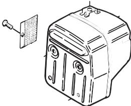
Certains silencieux sont munis d'une grille antifleme. Cette grille doit être nettoyée une fois par semaine si la machine en est équipée. Utiliser de préférence une brosse en acier. Un pare-étincelles colmaté risque de causer la surchauffe du moteur et de provoquer de sérieuses avaries du moteur.
