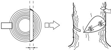
Le contrôle de la direction de chute de l'arbre fonctionne mal si la charnière est trop petite ou coupée trop profondément ou si les deux entailles ne coïncident pas.
