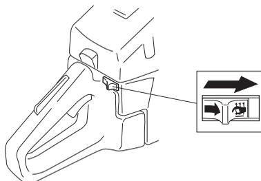
Pour mettre le chauffage, pousser le contact à droite.
