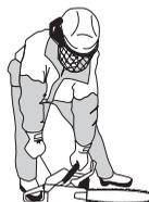
Enfoncer la commande de starter dès que le moteur s'emballé et répéter les lancements jusqu'au démarrage. Dès que le moteur démarre, appuyer et relâcher immédiatement la commande d'accélération. Ceci libère la gâchette d'accélération.
