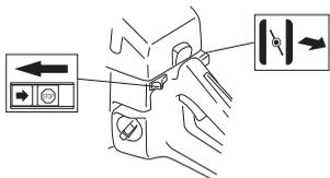
Si la machine est équipée d'un décompresseur (A): enfoncer celui-ci pour réduire la pression dans le cylindre et faciliter le démarrage de la machine. Toujours utiliser le décompresseur au démarrage. Une fois le moteur lancé, le décompresseur se remet automatiquement en position initiale.
