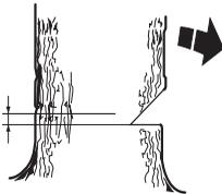
Le trait de chute doit s'achever parallèlement à l'encoche, l'espace entre les deux étant 1/10 du diamètre du tronc.
