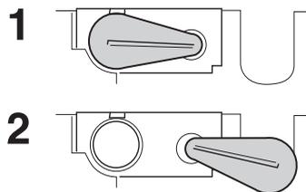
**REMARQUE!** Quand le bouchon est posé dans la buse d'air "Air injection", le filtre à air doit être nettoyé au moins une fois par jour.
