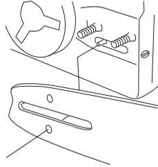
Tendre la chaîne en tournant le vis du tendeur de chaîne vers la droite à l'aide de la clé universelle. Tendre la chaîne jusqu'à ce qu'elle ne pende plus sous le guide.
