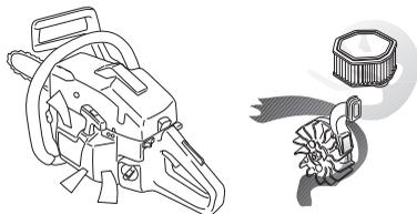
**IMPORTANT!** L'épuration centrifuge exige un entretien correct et continu de la machine. Nettoyer la prise d'air du lanceur, les ailettes du ventilateur, le compartiment du
