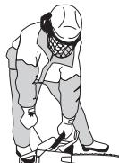
Натиснете смукача веднага след припалване на двигателя и повторете опитите за стартиране. Когато двигателят заработи вие трябва бързо да подадете пълна газ и положението са стартовата газ се изключва автоматично.
