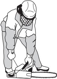
Uma vez que o travão da corrente continua activado, a rotação do motor deve ser baixada logo que possível para a marcha em vazio, o que se consegue desligando o bloqueio do acelerador. Deste modo pode evitar desgaste desnecessário da embraiagem, do tambor da embraiagem e das cintas de travagem.
