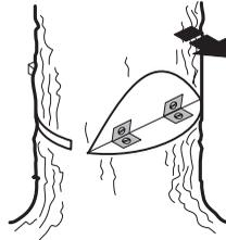
Perde-se todo o controlo sobre a direcção de queda da árvore se a linha de ruptura for demasiado pequena ou muito serrada, ou se o corte direccional e o corte de abate estiverem incorrectamente posicionados.
