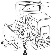
Monte a lâmina nos seus parafusos. Coloque a lâmina na sua posição mais atrás. Ponha a corrente sobre o pinhão e a ranhura da lâmina. Comece pela parte superior da lâmina. Verifique se o fio dos elos de corte está voltado para a frente, na parte superior da lâmina.
