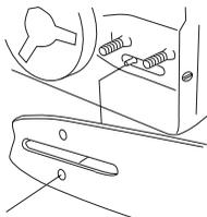
Estique a corrente, apertando com o auxílio da chave universal o parafuso esticador da corrente, no sentido horário. Estique a corrente até que esta deixe de estar frouxa na parte inferior da lâmina.
