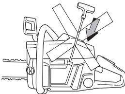
Rearme o travão da corrente levando a protecção contra o retrocesso em direcção ao arco dos punhos. A motosserra está agora pronta a ser usada.
