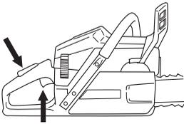
Comprima imediatamente para dentro o estrangulador quando o motor funcionar e faça renovadas tentativas até que o motor arranque. Quando o motor arrancar dê rapidamente aceleração total e a aceleração de arranque é automaticamente desligada.
