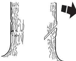
Depois, serre o corte inferior de modo que este termine exactamente onde termina o corte superior.
