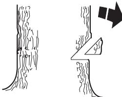
A profundidade do corte direccionado deve ser de 1/4 do diâmetro do tronco e o ângulo entre o corte superior e o inferior, no mínimo de 45°.
