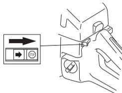
Il motore si ferma portando il contatto di arresto in posizione di arresto.
