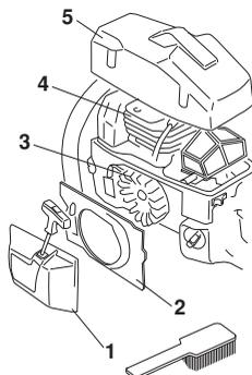
Pulire il sistema di raffreddamento con una spazzola una volta la settimana, più spesso se necessario. Se il sistema di raffreddamento è sporco o ostruito provoca il surriscaldamento della macchina, con conseguenti danni a cilindro e pistone.
