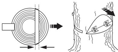
Se il fulcro è insufficiente, se è stato segato completamente o se il taglio direzionale è male eseguito, non è possibile controllare la caduta dell'albero.
