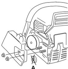
Montare la lama sui perni di fissaggio. Spingere la lama indietro al massimo. Sistemare la catena sopra la ruota motrice e farla passare nella scanalatura. Cominciare dalla parte superiore.
