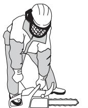
Premere immediatamente lo starter quando il motore dà segno di accendersi e ripetere il tentativo di avviamento fino a quando il motore parte. A questo punto mandare velocemente a pieno gas e il gas di avviamento verrà automaticamente disattivato.
