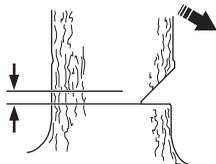
Inserire l'appoggio per la corteccia dietro il fulcro (se è stato montato l'apposito dispositivo). Lavorare a pieno gas e far avanzare la catena/lama lentamente nel tronco. Controllare che l'albero non si muova in direzione opposta
