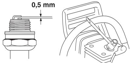
Osservare! Usare candele originali o di tipo raccomandato! Altre candele possono danneggiare cilindro e pistone. Controllare che la candela sia munita di dispositivo di soppressione interferenze radio.
