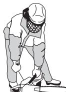
Pritisni regulator sauga odmah kad motor pali i ponavljaj pokušaje paljenja dok se motor ne upali. Kad je motor startova daj brzo puni gas i startni gas se automatski isljučuje.
