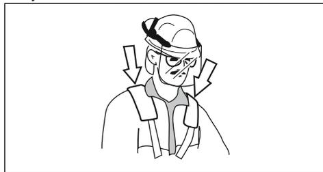
5. Seřídte nosný popruh tak, aby byl řezací nástavec rovnoběžný s povrchem terénu.
