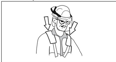
5. Wyregulować szelki tak, aby osprzęt tnący znajdował się równoległe do podłoża.
