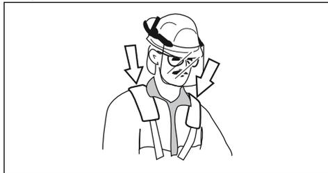
5. Nastavte si správnu polohu popruhov tak, aby bol rezací nastavec rovnobežne so zemou.
