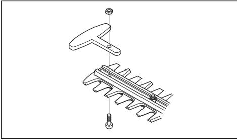
2. Montieren Sie die Schraube und die Mutter an der Schneideinheit und ziehen Sie sie auf 8 Nm an.
