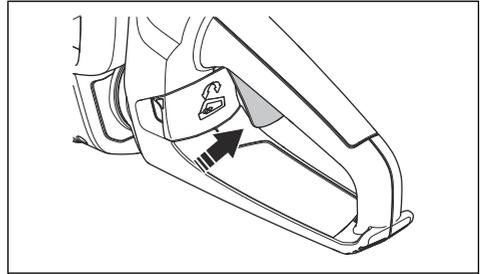
4. Lassen Sie den Gashebel los und stellen Sie sicher, dass die Rückzugfeder ordnungsgemäß funktioniert. Die Klinge muss in weniger als 1 Sekunde anhalten.
