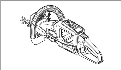
3. Um die volle Drehzahl anzuwenden, drücken Sie den Gashebel vollständig durch.
