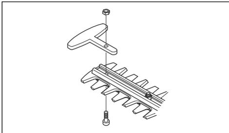
2. Namestite vijak in matico na rezalno enoto in privijte do 8 Nm.
