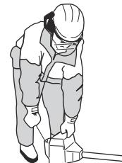
5. Pomalu vytáhněte rukojet' startovací šňury, než ucítíte odpor, a poté silou zatahнete za rukojet' startovací šňury.
