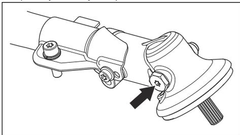
Консистентная смазка в угловой зубчатой передаче не нуждается в замене за исключением случаев выполнения ремонта.
