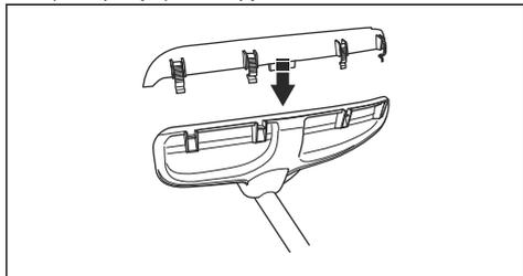
2. Закрепите дополнительное ограждение на щитке режущего оборудования с помощью 4 фиксирующих захватов.
