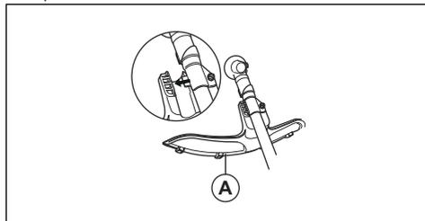
2. В обязательном порядке снимите дополнительное ограждение.
