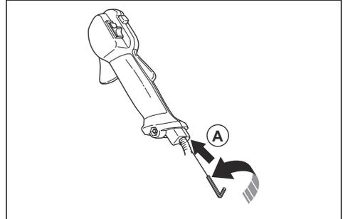
4. Если частота вращения при пусковом положении дросселя чрезмерно высокая, поворачивайте регулировочный винт (А) против часовой стрелки, пока режущее оборудование не остановится. Поверните регулировочный винт еще на 1/2 оборота.
