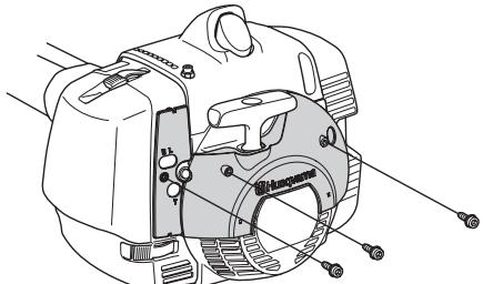
Ξεμοντάρετε το φίλτρο αέρα και το κάπακι φίλτρου αέρα του μηχανήματος. Τοποθετήστε το φίλτρο αέρα και το καπάκι φίλτρου αέρα που περιέχονται στο χειμερινό σετ.
