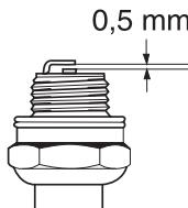
**ΠΡΟΣΟΧΗ!** Χρησιμοποιείτε πάντοτε τον τύπο μπουζιού που συστήνεται! Λάθος τύπος μπορεί να προκαλέσει ζημιά στο έμβολο/κύλινδρο. Ελέγξτε αν το μπουζί είναι εφοδιασμένο με συμπιεστή.
