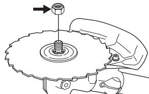
Κατά τη συναρμολόγηση, σφίξτε το παξιμάδι στρέφοντάς το αντίθετα προς τη φορά περιστροφής του εξαρτήματος κοπής. Χαλαρώστε το παξιμάδι για να το αφαιρέσετε, στρέφοντάς το κατά τη φορά περιστροφής του εξαρτήματος κοπής. (ΠΡΟΣΟΧΗ! το παξιμάδι έχει αριστερόστροφο σπείρωμα.) Οταν χαλαρώνετε και σφίγγετε το παξιμάδι της πριονωτής λεπίδας, υπάρχει κίνδυνος τραυματισμού από τα δόντια
