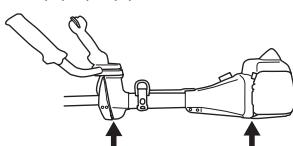
Τα επίπεδα κραδασμών αυξάνονται αν γίνει λανθασμένη περιτύλιξη του κορδονιού ή χρησιμοποιείται λανθασμένο εξάρτημα κοπής. Βλ. τις οδηγίες στο κεφάλαιο Κοπικός εξοπλισμός.
