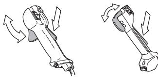
Δείτε τις οδηγίες του κεφαλαίου Εκκίνηση. Βάλτε σε λειτουργία το μηχάνημα και χρησιμοποιήστε πλήρες γκάζι.. Αφήστε το γκάζι και ελέγχετε εάν το εξάρτημα κοπής σταματάει και παραμένει ακινητοποιημένο. Εάν το εξάρτημα κοπής περιστρέφεται με το γκάζι στη θέση ρελαντί, πρέπει να ελεγχθεί η ρύθμιση ρελαντί του καρμπυρατέρ. Δείτε τις οδηγίες του κεφαλαίου Συντήρηση.
