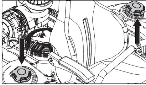
Lea las instrucciones de seguridad antes de cargar combustible. La capacidad para cada tanque es de 22,7 litros. Revise con regularidad la junta del tapón de la gasolina para ver si hay daños y mantenga la tapa debidamente apretada.
