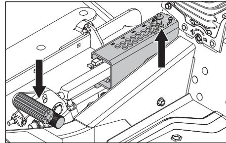
Los pedales de altura de corte sueltan la elevación del equipo para que se pueda ajustar la altura del equipo deseada. Aplique presión al pedal de elevación y gire el pie para también aplicar presión al pedal de liberación, desbloqueando la elevación del equipo.
