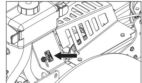
La válvula de corte de combustible está ubicada en la parte trasera derecha del asiento. La válvula tiene tres posiciones: depósito derecho y depósito izquierdo y cerrada.
