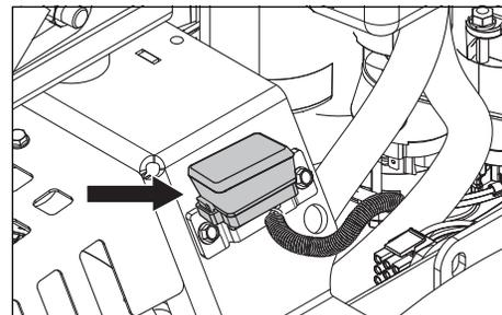
Los fusibles están situados en el lado derecho de la máquina y se accede a ellos inclinando el asiento hacia adelante. Los fusibles son de tipo plano como los que se usan en los automóviles. El de 20 A es el fusible principal. El de 7,5 A es para el acoplamiento del equipo de corte. El de 10 A es para los accesorios.
