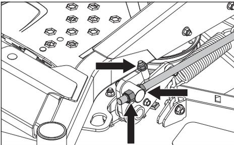
3. Gire ambas cuchillas exteriores para alinearlas con el equipo desde la parte delantera a la trasera. Cambie de posición los cáncamos de montaje hacia arriba o hacia abajo hasta que las puntas de las puntas traseras de la cuchilla estén de 3,175 mm a 9,525 mm más alto en la parte trasera que las puntas de la cuchilla delanteras.
