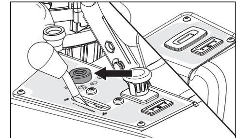
El interruptor de encendido se utiliza para arrancar y detener el motor. En los modelos equipados con faros, gire la llave en el sentido de las agujas del reloj, hasta la posición ACCESSORY (Accesorio) para usar los faros.
