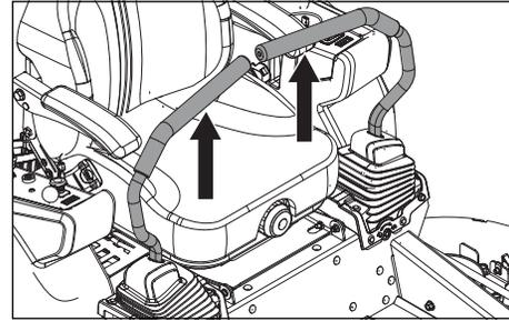
La velocidad y la dirección de la máquina son de tipo variable continua con los dos controles de la dirección. Los controles de la dirección se pueden mover hacia adelante o hacia atrás sobre una posición neutra. Además, hay una posición neutra que se bloquea si los controles de la dirección se mueven hacia afuera.
