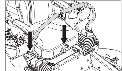
El asiento se puede ajustar longitudinalmente con la palanca situada en el lado derecho del asiento. Cuando se realizan ajustes, la palanca se mueve hacia arriba.
