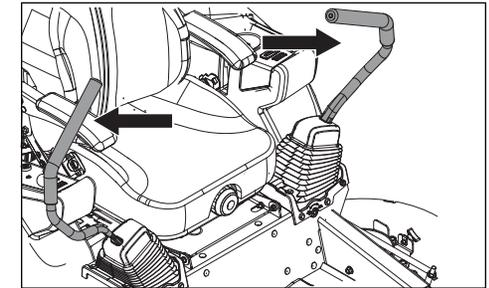
El freno de estacionamiento está integrado con las palancas de control de la dirección. Mueva las palancas hacia afuera de la posición neutra para acoplar el freno de estacionamiento.
