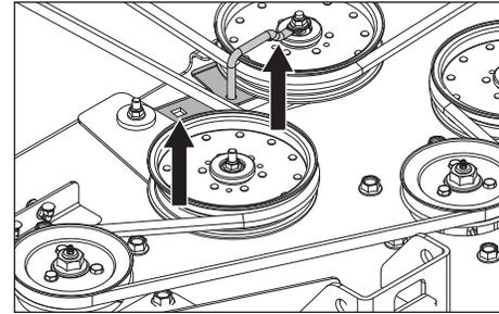
4. Con una barra de palanca de 1/2" y utilizando la abertura cuadrada del brazo guía, gire el brazo contra el sentido de las agujas del reloj para liberar la tensión de la correa.
