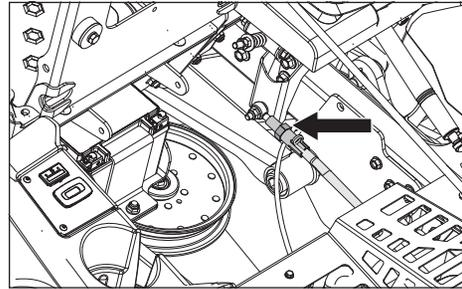
4. Retire y guarde el pasador del acoplador delantero.
