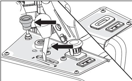
6. Ajuste la válvula del depósito de combustible al depósito deseado.
