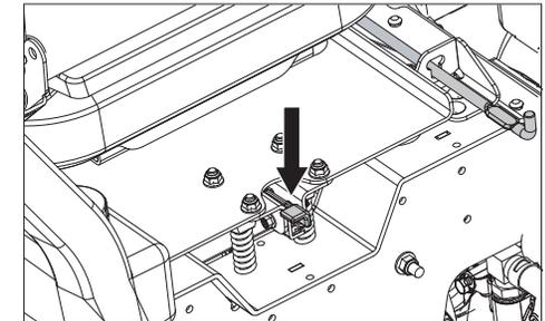
El asiento se puede girar hacia delante para acceder a la batería del cortacésped y al equipo hidráulico. Presione hacia abajo la palanca del seguro para liberar el asiento. Levante el asiento hasta que la varilla se acople.
