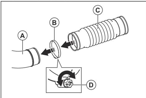
2. Φροντίστε να τοποθετήσετε τη βίδα του σφιγκτήρα (D) όπως υποδεικνύεται στην εικόνα. Σφίξτε τη βίδα.
