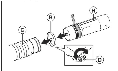
5. Φροντίστε να τοποθετήσετε τη βίδα του σφιγκτήρα (D) όπως υποδεικνύεται στην εικόνα. Σφίξτε τη βίδα.
