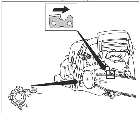
6. ガイドバーの穴をチェン調整ピンに合わせて、クラッチカバーを取り付けます。
