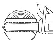
b) 幹の  $1/3$  が残るまで引き切りで切断します。
