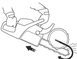
**警告:** ソーチェンが幹に引っかかると、製品が作業者に向かって押し出されます。製品をしっかりと持ち、ガイドバーのキックバックゾーンが木に触れておらず、キックバックが発生しないことを確認します。
