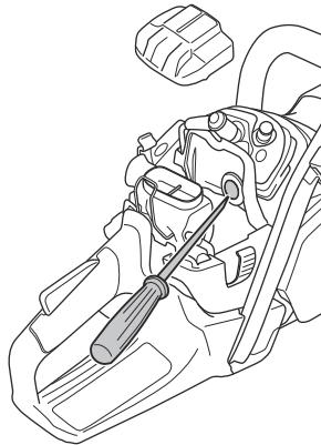
3. 5°Cを下回る気温や降雪に対凍するため、冬用カバーをご用意しています。スターターハウジングにこの冬用カバーを取り付けます。冬用カバーは、キャブレータースペースへの冷気の流入を低減し、雪が侵入するのを防ぎます。
