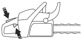
8. フロントハンドガードを後方に動かして、チェンブレーキを解除します。
