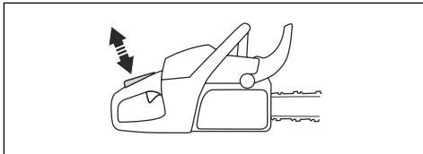
3. スロットルトリガーロックを放したとき、スロットルトリガーがアイドリングの位置にロックされていることを確認します。
