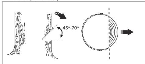
a) 受け口上部を作ります。本製品の伐倒方向マーク (1) と木の伐倒方向 (2) を合わせます。本製品の後ろに立ち、木が左側に来るようになります。引き切りで切断します。
