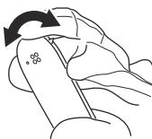
7. Drehen Sie die Führungsschiene täglich zur Verlängerung der Lebensdauer.
