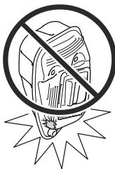
Der Schalldämpfer senkt den Geräuschpegel so weit wie möglich und hält die Abgase des Motors vom Anwender fern. In Bezug auf den Schalldämpfer ist es sehr wichtig, dass Sie die Kontroll-, Wartungs- und Serviceanweisungen stets befolgen.
