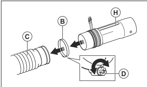
5. Ügyeljen arra, hogy a bilincs csavarját (D) az ábrán látható módon helyezze be. Húzza meg a csavart.
