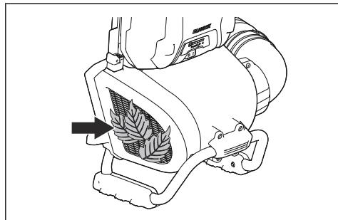
2. Ak je to potrebné, vypnite výrobok a odstráňte nežiadúci materiál.
