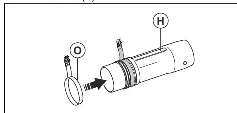
4. Nasadte svorku (B) na ohybnú trubicu (C) a pripojte otočný kľb (H).
