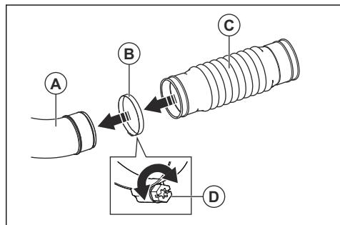
2. Ügyeljen arra, hogy a bilincs csavarját (D) az ábrán látható módon helyezze be. Húzza meg a csavart.
