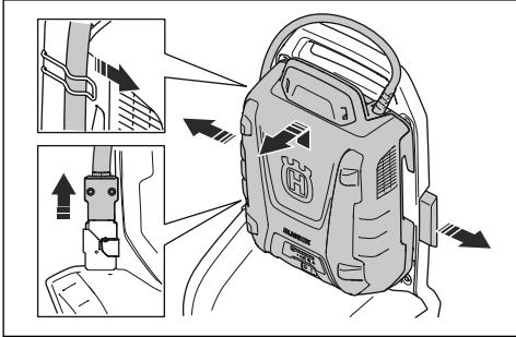
5. Odpojte kábel od konektora.
