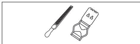
1. Χρησιμοποιήστε μια επίπεδη λίμα και ένα όργανο μέτρησης βάθους για να προσαρμόσετε τη ρύθμιση του μετρητή βάθους. Χρησιμοποιήστε μόνο το όργανο μέτρησης βάθους της Husqvarna για να επιτύχετε τη σωστή ρύθμιση του μετρητή βάθους και τη σωστή γωνία για το μετρητή βάθους.
