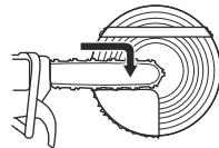
3. Τοποθετήστε μια σφήνα μέσα στην εγκοπή σε ευθεία από το πίσω μέρος.
