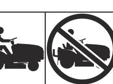
Nie wolno obsługiwać urządzenia bez zamontowania pojemnika na trawę lub deflektora.
