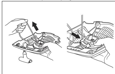
5. Uklonite središnji vijak, pogonski disk (A), oprugu pogonskog diska (B) i remenicu (C).
