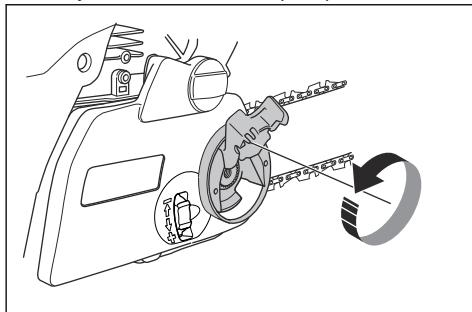
3. Okrenite točak zatezača lanca prema dolje (+) kako biste povećali zategnutost lanca pile. Okrenite točak zatezača lanca prema gore (-) kako biste smanjili zategnutost lanca pile.
