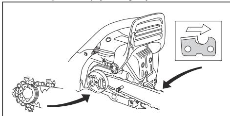
6. Poravnajte otvor u vodilici s iglom za podešavanje lanca i postavite poklopac kvačila.
