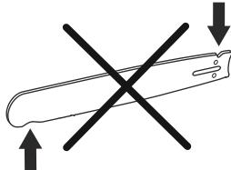
6. Vodite računa da se lančanik vrha vodilice nesmetano okreće i da otvor za podmazivanje lančanika vrha vodilice nije zakrčen. Očistite i podmažite ako je potrebno.
