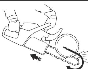
**警告：**如果锯链卡在树干中，产品可能会被推向您所在的方向。牢牢握住产品，确保导板反弹区不会接触树木而导致反弹。
