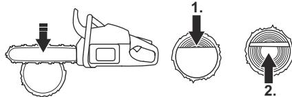
**警告：** 如果锯链被卡在树干中，必须停止引擎。用杠杆将切口打开，然后取出本产品。切勿尝试用手拉出本产品。如果本产品突然被抽出，则有可能导致伤害。
