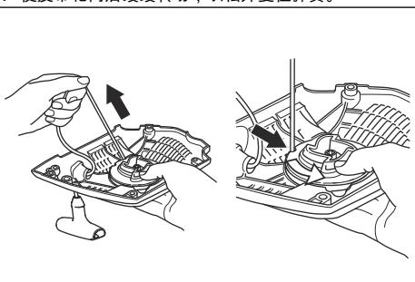
5. 卸下中心螺钉、驱动盘 (A)、驱动盘弹簧 (B) 和皮带轮 (C)。
