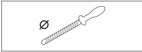
如果不使用适合的锉削设备，则很难正确磨利锯链。使用 Husqvarna 建议的锉规。这将有助于保持最大锯切性能，并将反冲危险降至最低。
