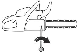
5. 用扳手拧紧导板螺母，同时提起导板前部。
