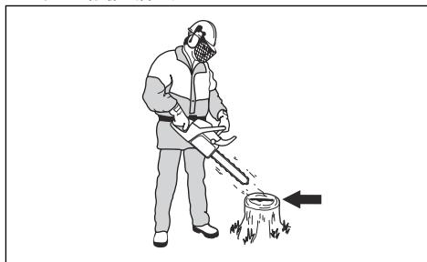
3. 如果锯链润滑工作不正确，则检查导板。有关说明，请参阅 [检查导板在第 28 页上](#)。如果维护步骤无所帮助，请联系保养代理商。
