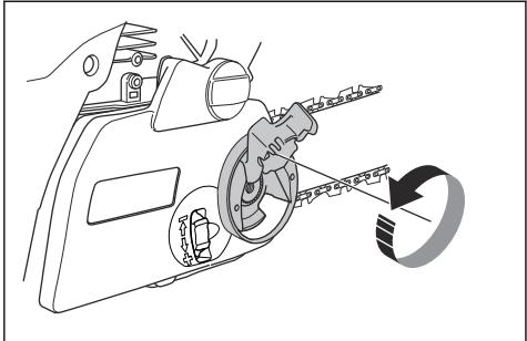
3. 向下转动链张紧转轮 (+) 可增大锯链的张力。向上转动链张紧转轮 (-) 可减小锯链的张力。
