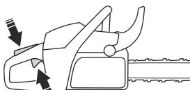
8. 将前护手板向后移动可松开链制动器。
