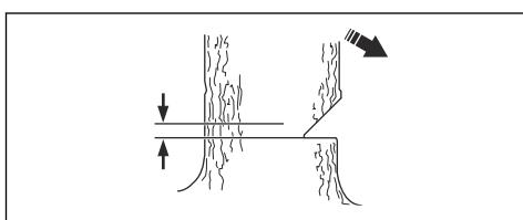
**CẢNH BÁO:** Hãy cẩn thận khi bạn cắt bằng mũi lam dẫn hướng. Bắt đầu cắt ở phần thấp hơn của mũi lam dẫn hướng khi bạn tạo nhát lách vào thân cây.
