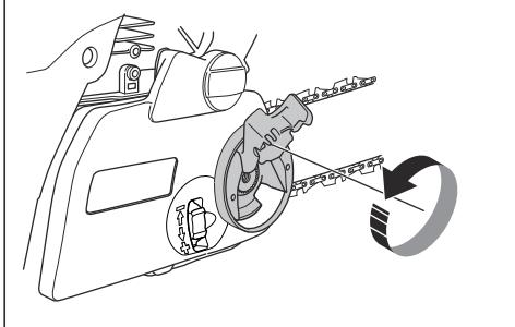
3. Vặn bánh điều khiển thiết bị tăng xích xuống (+) để tăng xích. Vặn bánh điều khiển thiết bị tăng xích lên (-) để giảm tăng xích.
