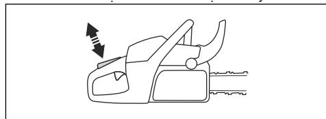
3. Đảm bảo tay điều khiển van tiết lưu được khóa ở vị trí không tải khi nhả khóa điều khiển van tiết lưu.
