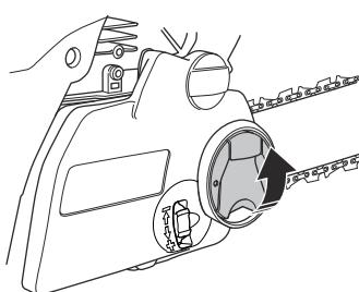
2. Vặn núm điều khiển ngược chiều kim đồng hồ để nới lỏng nắp ly hợp.
