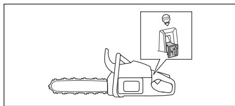
**CẢNH BÁO:** Công tắc khởi động/dừng tự động trở lại vị trí khởi động. Để ngăn vô tình khởi động, hãy tháo nắp bu-gi ra khỏi bu-gi khi bạn lắp ráp hoặc bảo trì sản phẩm.
